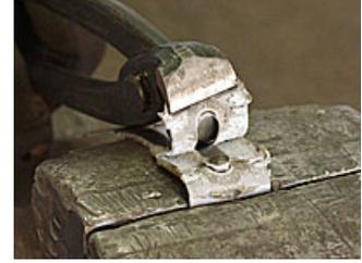
FIG. 3.2 – Exemple d'essai de pelage.
