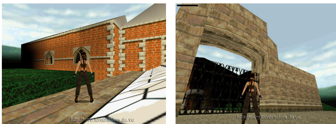
Figure C.2 L'apposition de texture structurées provoque souvent des artefacts gênants: texture mal appliquée, répétitions de structure, résolution limitée. (Image de [tom])
