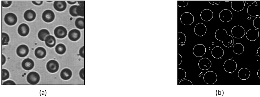
Figure 1.15 : Illustration de la détection de contours. (a) Image originale ; (b) Détection des contours par une méthode dérivative.
