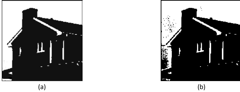
Figure 3. 8: Segmentation de l'image maison par H_{Sh} en : (a) Deux classes t=197 ; s=254 , (b) Trois classes t=(30;194) ; s=(8;251) .
