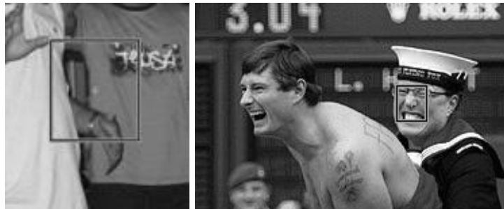
FIG. 7.31: Résultat de la détection de visages - cas d'une fausse alarme, et d'une non-détection d'un visage de profil
