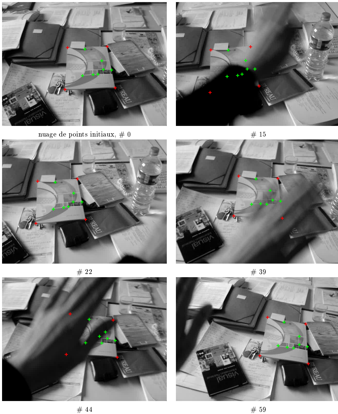
FIG. 8.1: Séquence BureauOcclusion – Résultats obtenus par le TFNLC-RB ; les points de référence sont en rouge, et les points attachés en vert.
