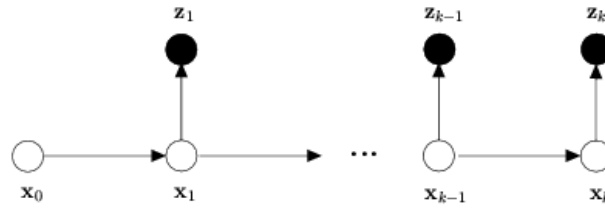
FIG. 0.1: Graphe de dépendance orienté de la chaîne de Markov cachée constituée des processus \mathbf{x}_{0:k} et \mathbf{z}_{1:k}
