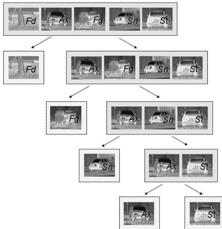
Figure 4.16: Hiérarchie de classes apprise sur la base Bertin. Les feuilles sont indiquées par des hachures. Fd: fond, Ax: Citron AX, Fg: Fourgonnette, Sn: Renault Scenic, St: Seat Ibiza. Les classes séparées du reste en premier sont celles qui s'en différencient le plus: le fond puis la fourgonnette.
