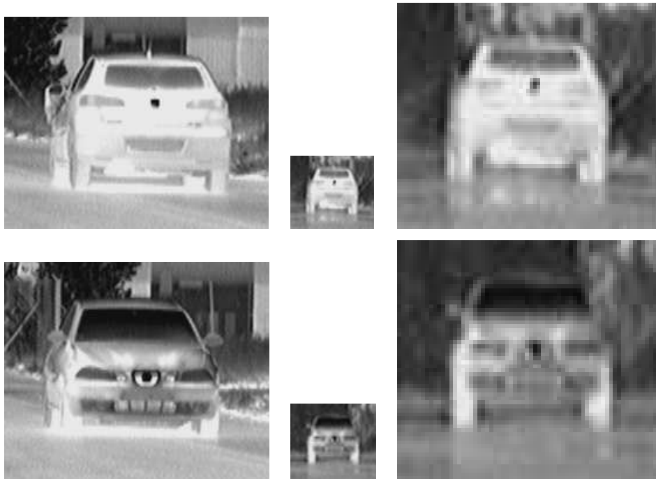
Figure 4.7: En infra-rouge, l'éloignement d'un véhicule se traduit par un changement de taille apparente, mais aussi par un changement de résolution et une homogénéisation du signal reçu par la caméra. Les deux lignes montrent le même véhicule, vue arrière et avant. Colonne 1: véhicule vu à 100 mètres. Colonne 2: véhicule vu à 600 mètres. Colonne 3: agrandissement de la colonne 2. Par exemple la hauteur de l'image (telle qu'elle est acquise par la caméra) ligne 1 colonne 1 est de 71 pixels, celle de la ligne 1 colonne 2 est de 25 pixels.
