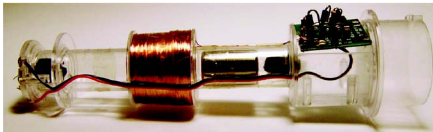
Figure 1-6 Lampe torche utilisant un générateur électromagnétique [1]
