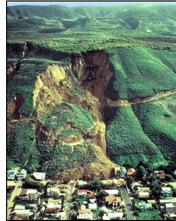
Figure 58: Glissement rotationnel (Varnes, 1978) – Glissement de le Conchita – Californie, 1995 (http://education.usgs.gov/schoolyard/IMAGES/)
