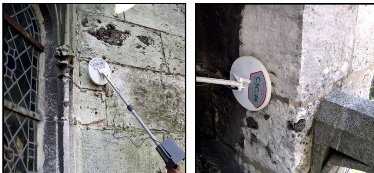
Figure 10 : Prospections au détecteur de métaux au niveau de barlotières-tirants et de balustrades, église Saint-Ouen.
