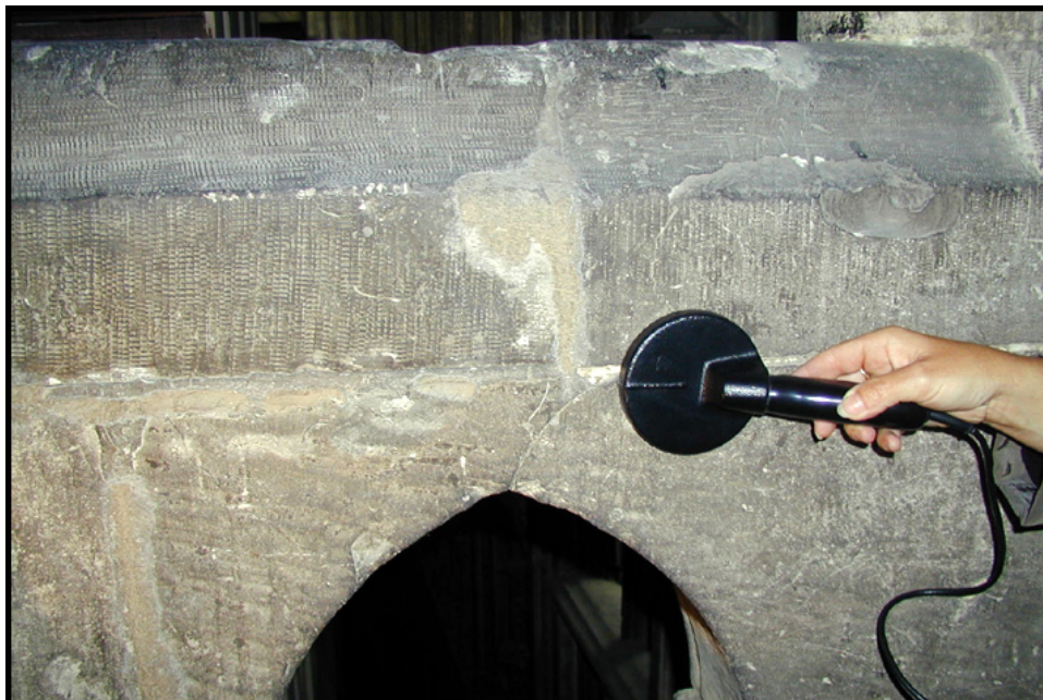
Figure 36 : Résultats des prospections au détecteur de métaux dans le triforium de la nef de la cathédrale de Rouen. En haut, cartographie des échos relevés d'après un dessin de Sauvageot ; à gauche, travées 1 à 5 ; à droite, travées 6 et 7. En bas, localisation de l'écho horizontal obtenu au niveau de ces balustrades, cliché Ph. Dillmann.
