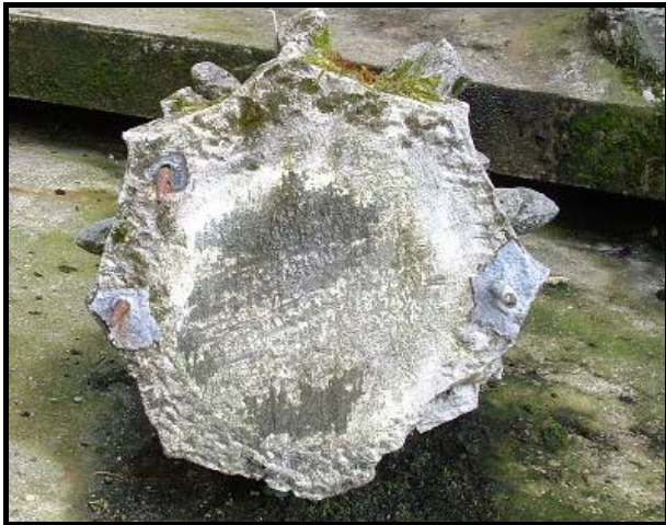
Figure 131 : Fleurions provenant d'une purge du transept nord de l'église Saint-Ouen avec agrafes (OUEN 03) et goujons (OUEN 05).
