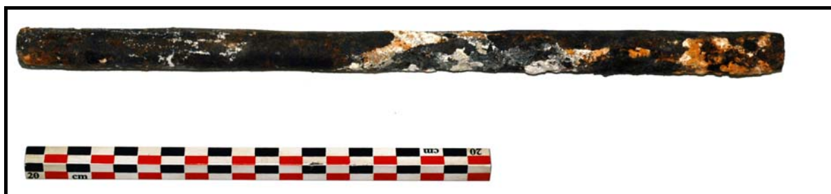
Figure 254 : Goujon MAD 01, section circulaire.
