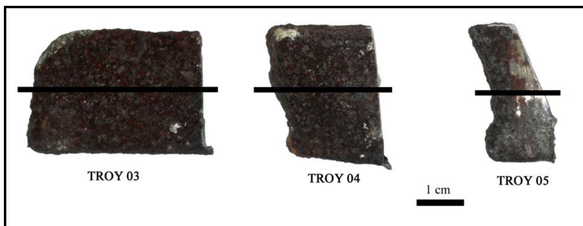
Figure 185 : Corpus d'étude métallographique avec schéma de découpe des barres attachant les colonnettes des arcs-boutants du chœur de la cathédrale de Troyes.
