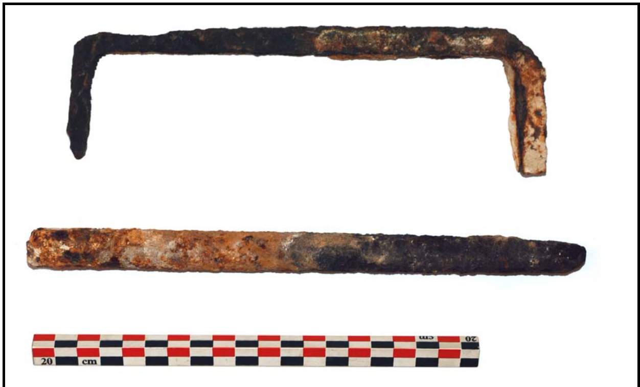
Figure 142 : Agrafe OUVEN 20 et goujon OUVEN 21 prélevés dans une gargouille de la nef de l'église Saint-Ouen de Rouen.
