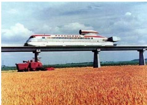
Figure 2 : l'Aérotrain, le 180-HV, accueillant 80 passagers<sup>148</sup>.
