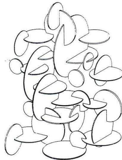
Figure 1.10 Application du modèle de disques de Baecher. [21]
