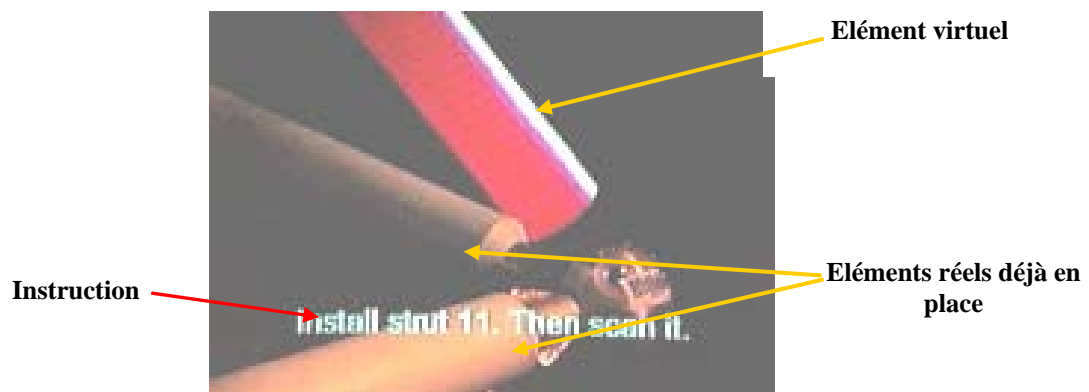
Figure 1.29. Ce que voit l'utilisateur du système ARC à travers son casque de visualisation
