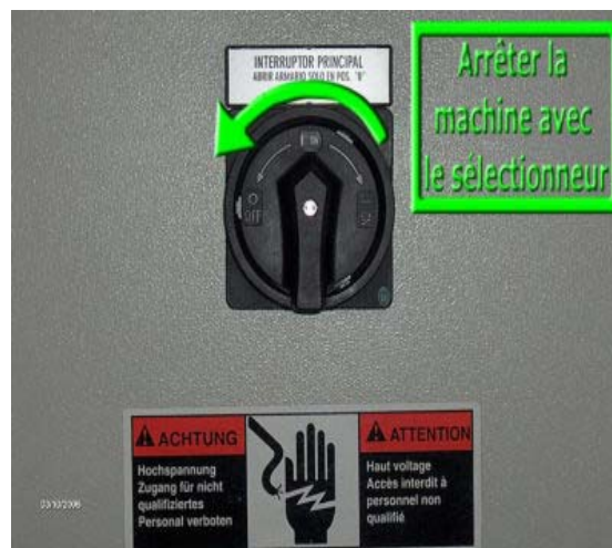
Figure 4. 14. Augmentation indiquant au technicien comment couper l'alimentation
