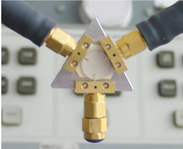
FIG. 4.11: Photo détaillée du dispositif de mesure (mesure d'un disque de YIG métallisé). Le troisième port est chargé par 50\Omega , comme c'est le cas des circulateurs utilisés comme isolateurs.
