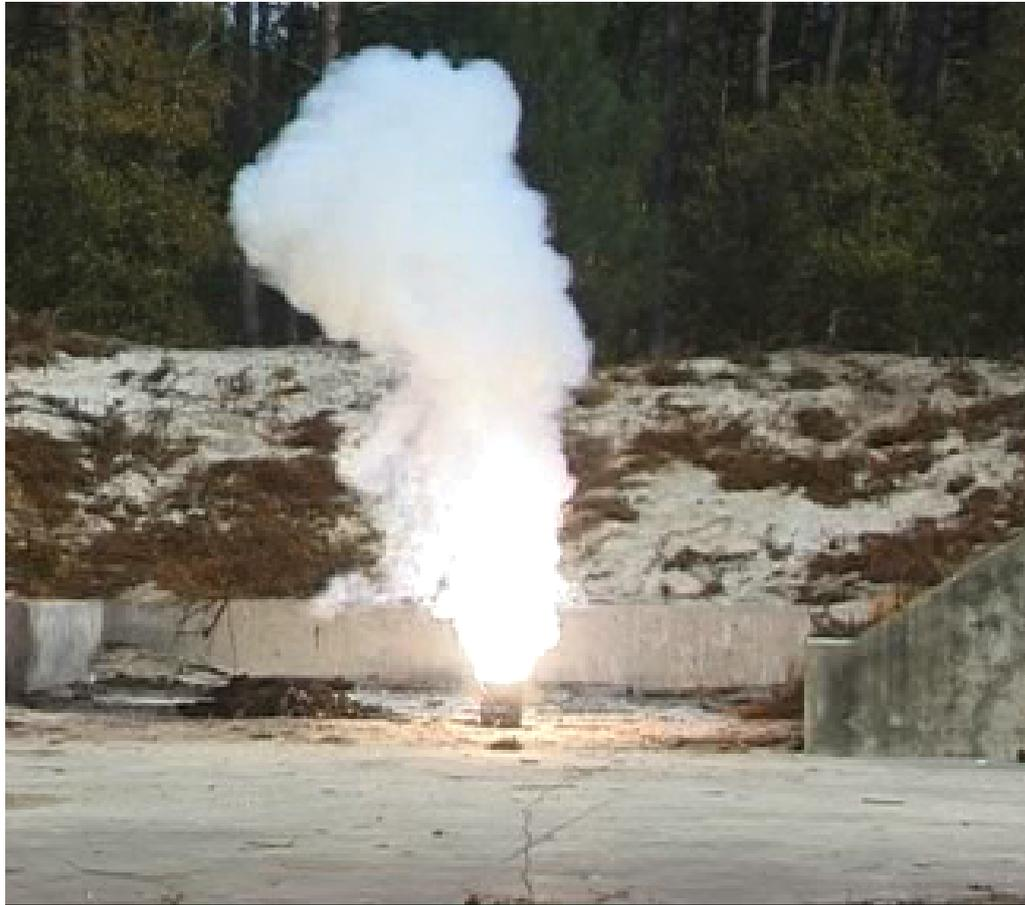
FIG. 1.2 – Feu de propergol solide aluminisé (20%Al) lors d'un essai d'allumage (CAEPE-2006)
