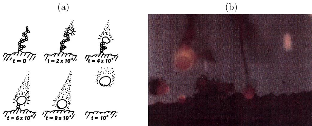
FIG. 3.3 – (a) Schématisation du mécanisme de formation d'un globule [8] (b) Prise de vue de la combustion de gouttes d'Al au-dessus de la surface d'un propergol PA/PBHT/Al ( $p = 0,6$  MPa) [9]
