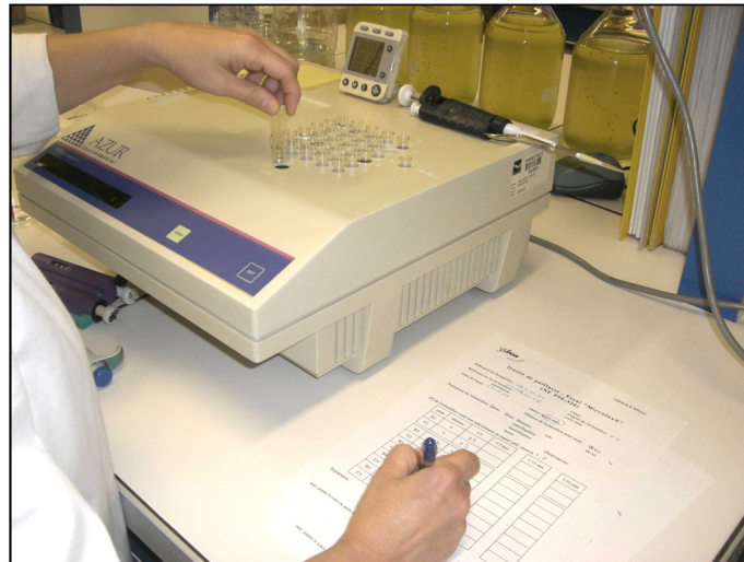
Figure 17 : Dispositif expérimental de l'essai microtox
