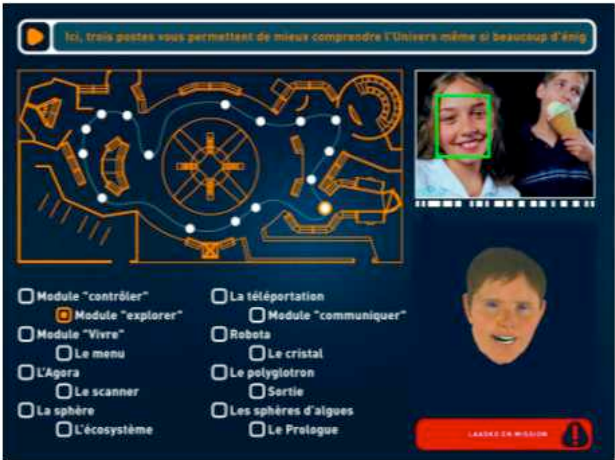
FIG. 3.4 – Ecran exploité pour l'interface Homme-Robot, avec affichage de la carte sémantique de l'environnement, contenant les noeuds du modèle topologique.
