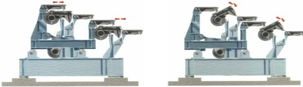
Figure 1.4 Brassage d'une charge d'ordures ménagères à l'aide de barreaux tournants [SEGHERS, 2006]
