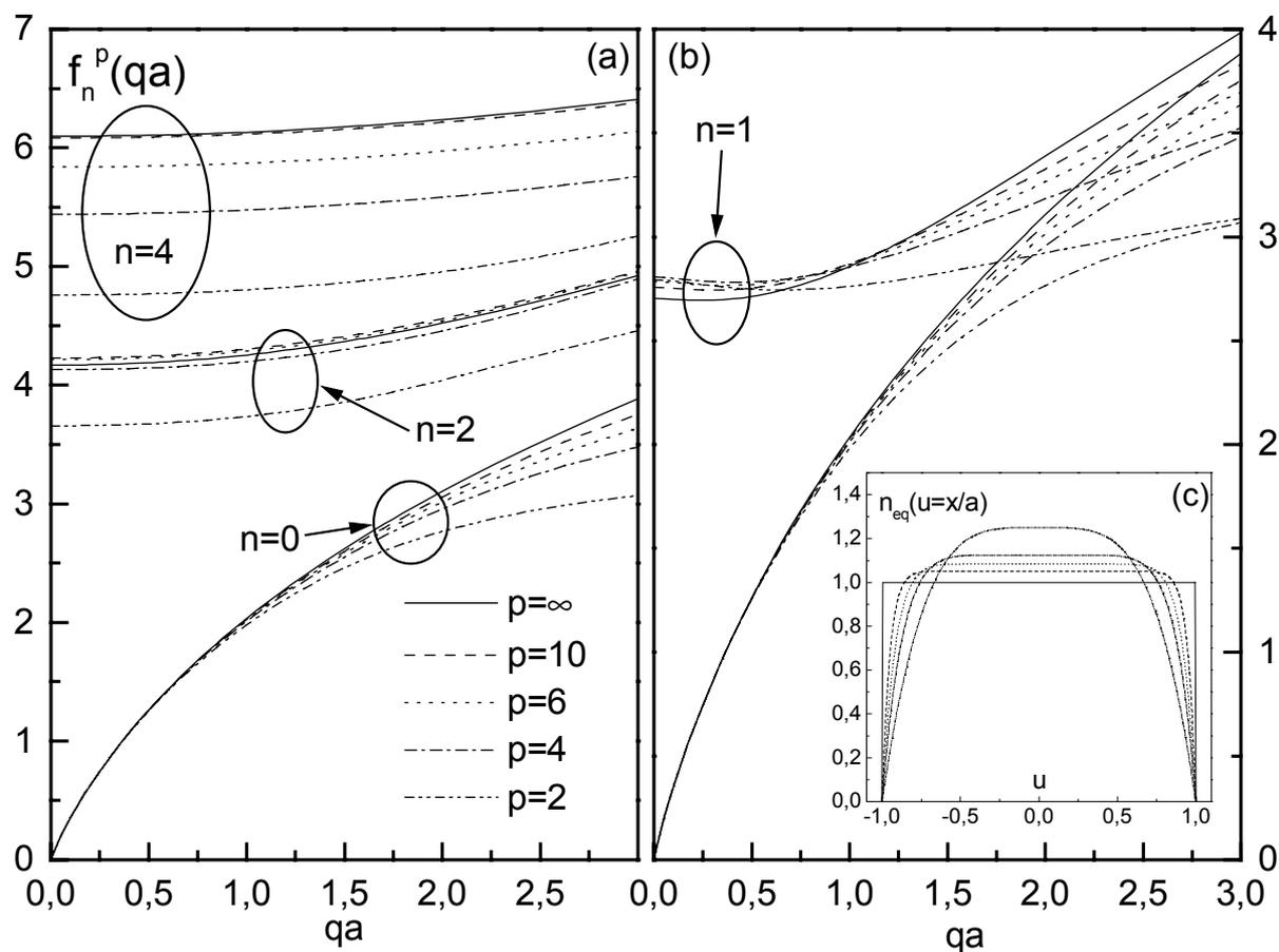
**Figure 4.19** (a) : dispersion des plasmons dans un profil mou. Par souci de lisibilité de la figure, seuls les modes symétriques sont montrés. (b) : dispersion des modes d'interface 0 et 1 les mêmes profils mous. © : profils correspondant aux différentes valeurs de  $p$  utilisées.
