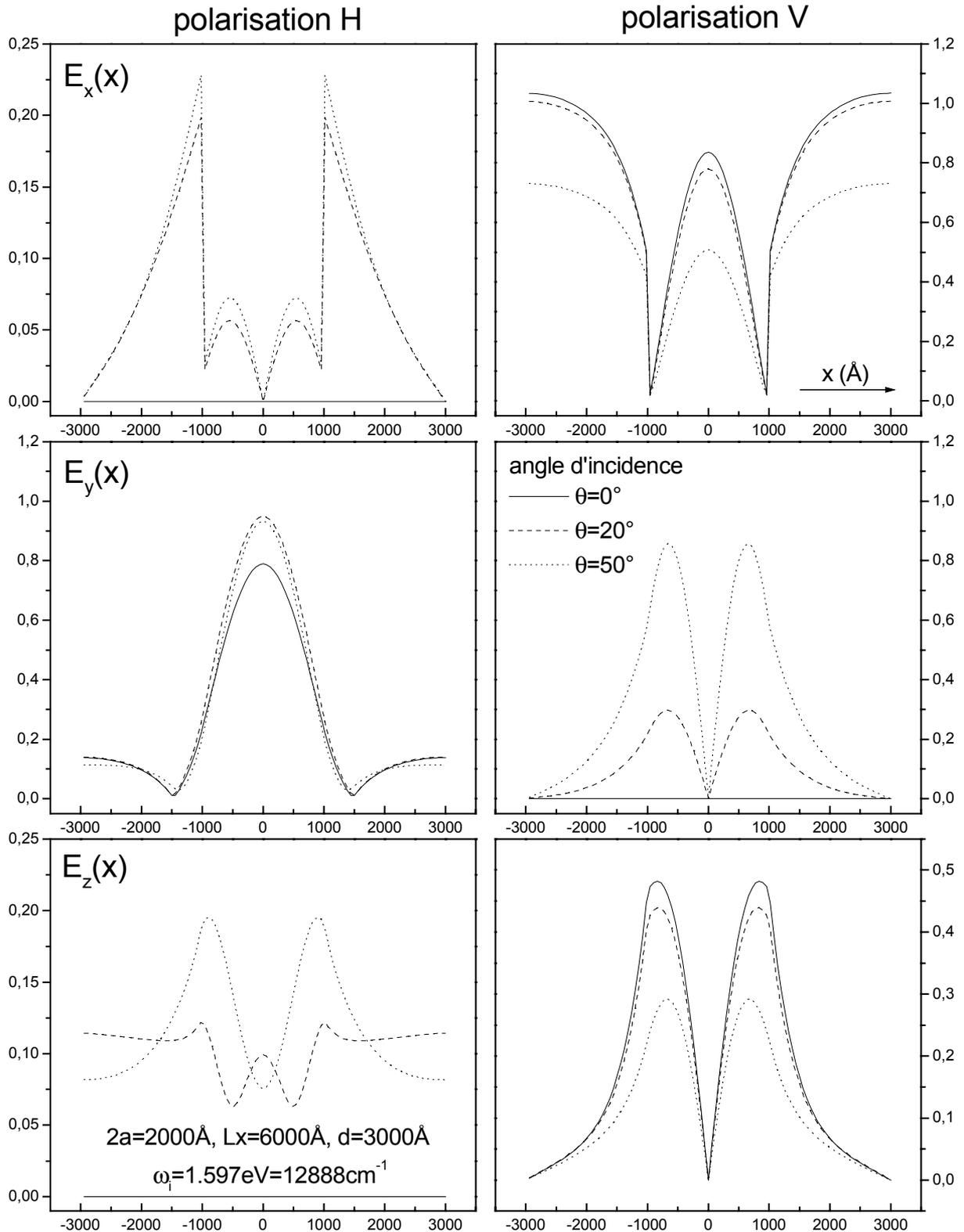
**Figure 3.7** Profil du module des composantes du champ  $E$  calculé au niveau du plan du gaz d'électrons ( $z=0$ ). Ils ont été calculés pour trois angles d'incidence de  $0^\circ$ ,  $20^\circ$ ,  $50^\circ$ , en incidence parallèle avec polarisation H et V (d'après Skrzypek [1997]).
