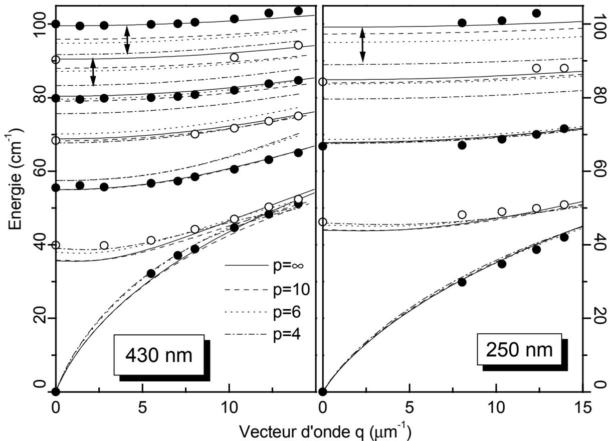
**Figure 4.20** Meilleur ajustement des dispersions expérimentales avec les dispersions des plasmons dans des profils mous de la densité d'équilibre, à gauche, pour le fil de 430 nm, à droite, pour celui de 250 nm.
