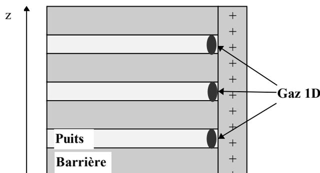
L'inconvénient majeure de cette technique est l'épaisseur « utile » de l'échantillon, c'est à dire celle qui contient les fils quantiques ; Celle-ci est de l'ordre du micromètre. Cela rend extrêmement difficile la réalisation de contacts du gaz d'électrons et ajoute une difficulté technique supplémentaire aux études optiques qui doivent être résolues spatialement. Par contre sa géométrie la rend très adaptée pour les lasers à fils quantiques.
