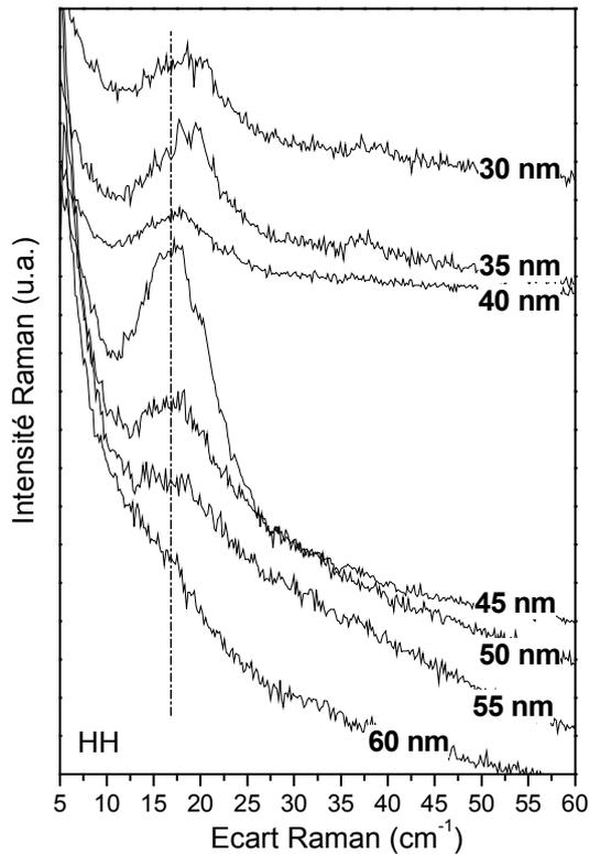
**Figure 4.25** Spectres Raman montrant l'évolution de la position de la raie non-dispersive en fonction de la largeur du fil.
