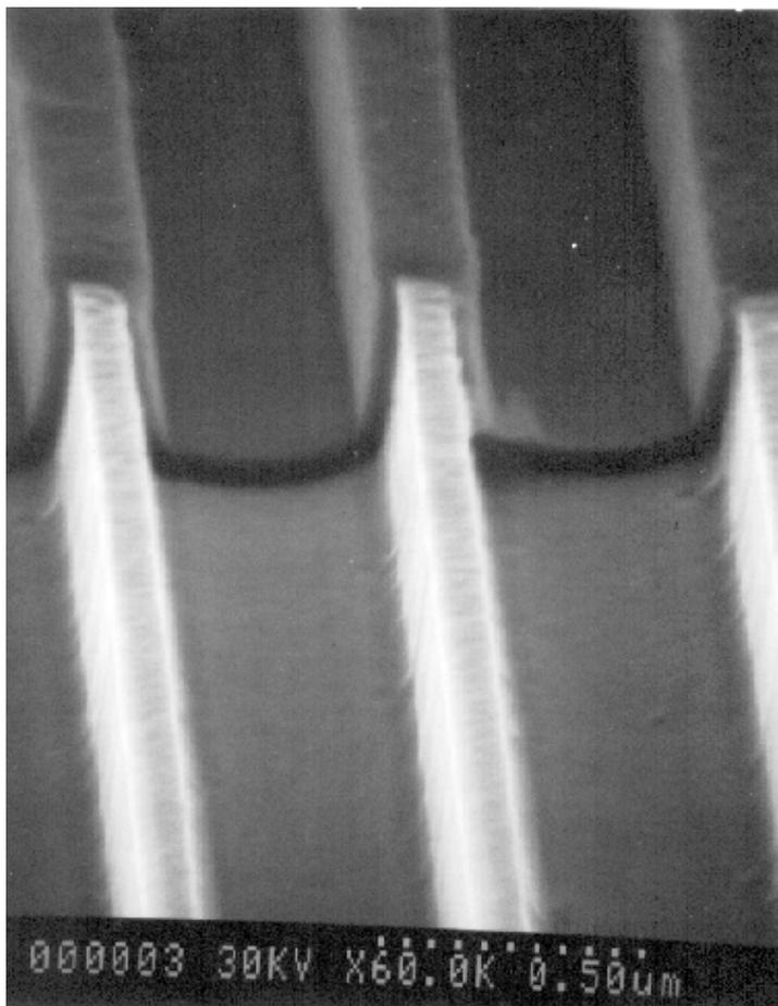
**Figure 4.5** Photographie d'une image obtenue par microscopie à balayage électronique du réseau de fils de 100 nm de l'échantillon JB08. On distingue nettement la couche d'oxyde (couche foncée) et le cœur non-oxydé des fils (en clair sur la photo)
