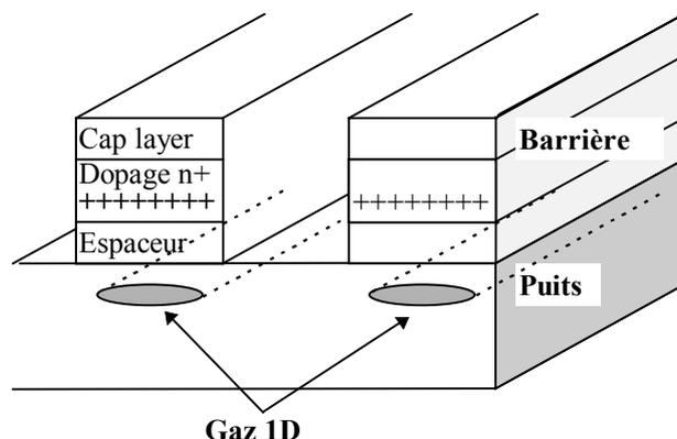
Les électrons sont confinés par le potentiel créé par la couche de donneurs ionisés. L'amplitude du potentiel est évidemment plus faible que celle obtenue par gravure profonde. Mais les défauts introduits par la gravure n'atteignent pas le plan du gaz.
