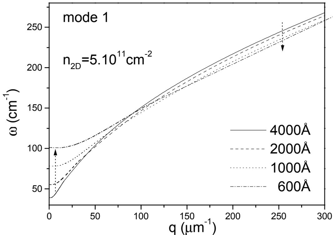
**Figure 2.15** Dispersion du mode  $n=1$  pour quatre fils de largeur 4000Å, 2000Å, 1000Å et 600Å. Tous ont la même densité 2D d'électrons. Les énergies évoluent en sens opposés, suivant que la contribution longitudinale ou transverse est prépondérante.
