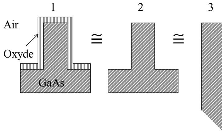
Pour trouver le potentiel intérieur au fil d'une charge, elle même placée à l'intérieur du fil, il faut sommer sur toutes les charges images issues des multiples réflexions sur toutes les faces de la structure 3. A chaque réflexion la charge est multipliée par le coefficient de réflexion :  $(\epsilon_{Air} - \epsilon_{GaAs}) / (\epsilon_{Air} + \epsilon_{GaAs}) < 1$ .
