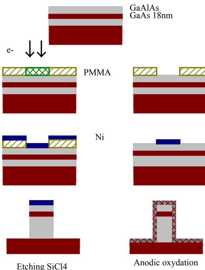
**Figure 1.2** Description du processus technologique de fabrication des fils quantiques De haut en bas et de gauche à droite : 1- puits quantique à modulation de dopage., 2-dépôt de la résine PMMA et insolation au masqueur électronique, 3- révélation, les zones insolées sont dissoutes, 4- dépôt d'une couche de 40 nm de Nickel par évaporation, 5- lift-off, le PMMA restant est dissous dans le trichloéthylène, 6- Gravure RIE, 7- Oxydation anodique.
