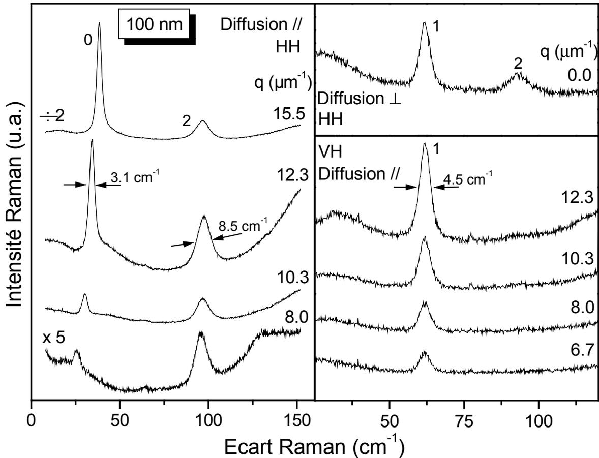
**Figure 4.15** Spectres Raman obtenus sur les réseaux de fils de 100 nm de large pour différentes configurations : à gauche, diffusion et polarisations parallèles, en bas à droite, diffusion parallèle et polarisations perpendiculaires, en haut à droite, diffusion perpendiculaire et polarisations parallèles.
