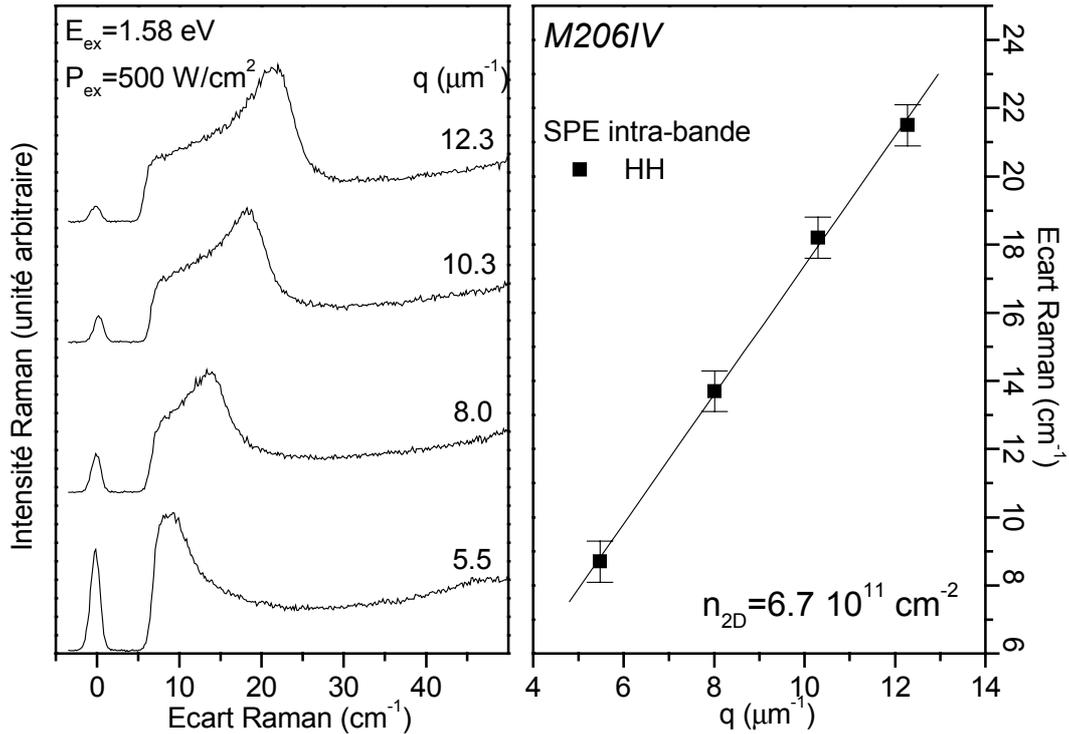
**Figure 4.9** A gauche, spectres Raman obtenus en polarisation parallèle (HH) sur le gaz bi-dimensionnel de l'échantillon M206IV pour différents vecteurs d'onde. Les spectres montrent la raie des SPE intra-bande associées à la première sous-bande du puits quantique. La visibilité des SPE est favorisée lorsque l'énergie du laser est proche de la transition  $E_2H_1$ . A droite, extraction de la densité d'électrons par ajustement de la dispersion du maximum de la raie avec la formule (4.4).
