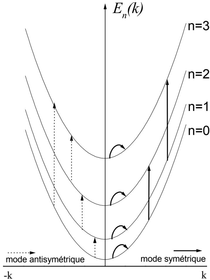
**Figure 2.17** Illustration des plasmons dans la RPA. Les modes symétriques sont des combinaison de toutes les transitions symétriques ( $\Delta n=0, 2, \dots$ ) alors que les modes antisymétriques sont des combinaisons de toutes les transitions antisymétriques ( $\Delta n=1, 3, \dots$ ).
