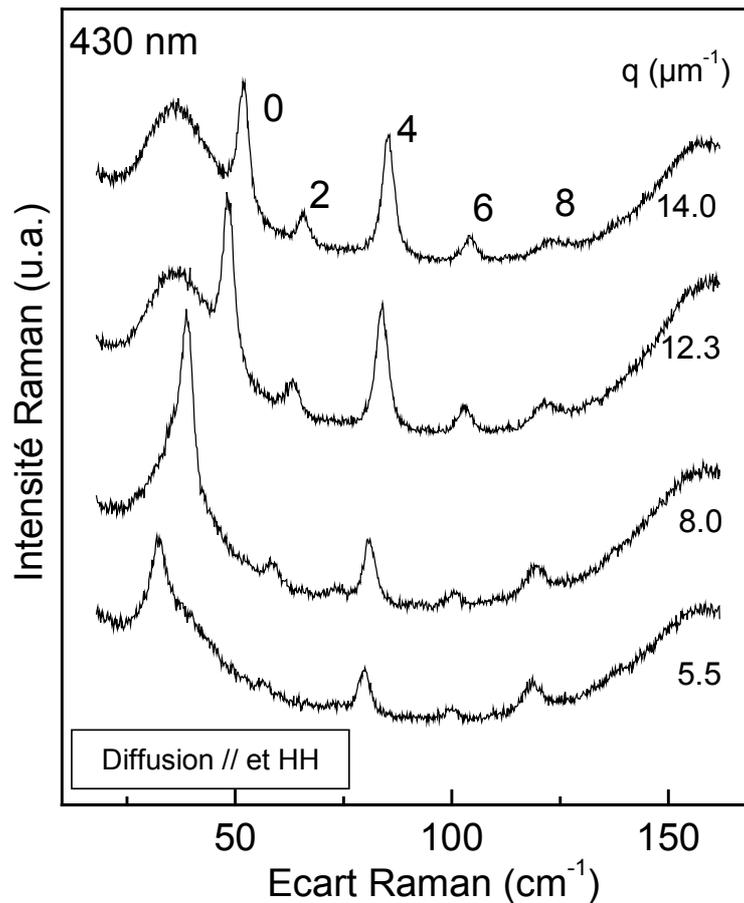
**Figure 4.11** spectres de diffusion Raman obtenus sur les fils de 430 nm de large en diffusion parallèle et polarisation parallèle (HH) pour différents vecteur d'onde. Les raies sont numérotées arbitrairement par 0, 2, 4 ... La bosse autour de  $30 \text{ cm}^{-1}$  est une transition inter-sousbande
