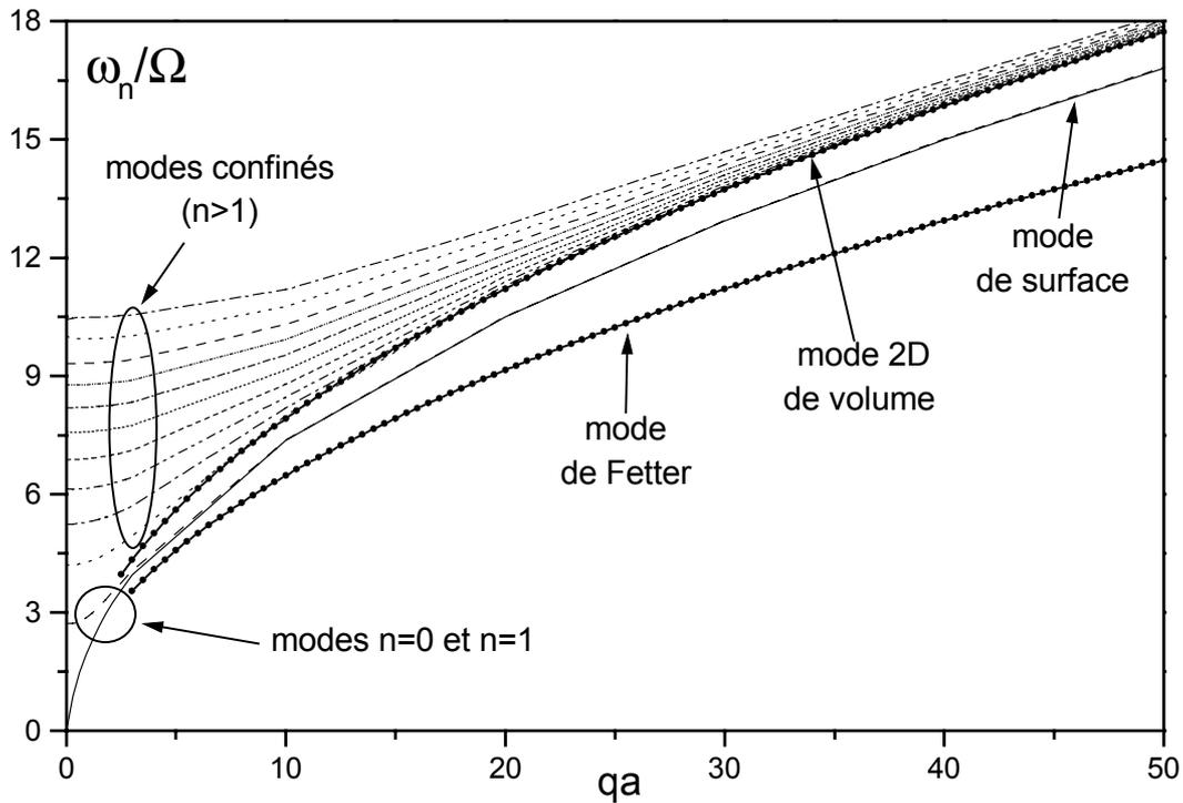
**Figure 2.12** Dispersion des plasmons dans un gaz quasi-unidimensionnel. Le calcul a été effectué pour des longueurs d'ondes beaucoup plus petite que la largeur du gaz ( $qa \gg 1$ ). La dispersion montre la convergence des modes 0 et 1 vers le mode de surface du gaz 2D semi-infini, alors que tous les autres modes rejoignent le mode de volume du gaz 2D. On notera les dispersions différentes du mode de surface calculé dans l'approximation de Fetter et avec le modèle d'Eliasson.
