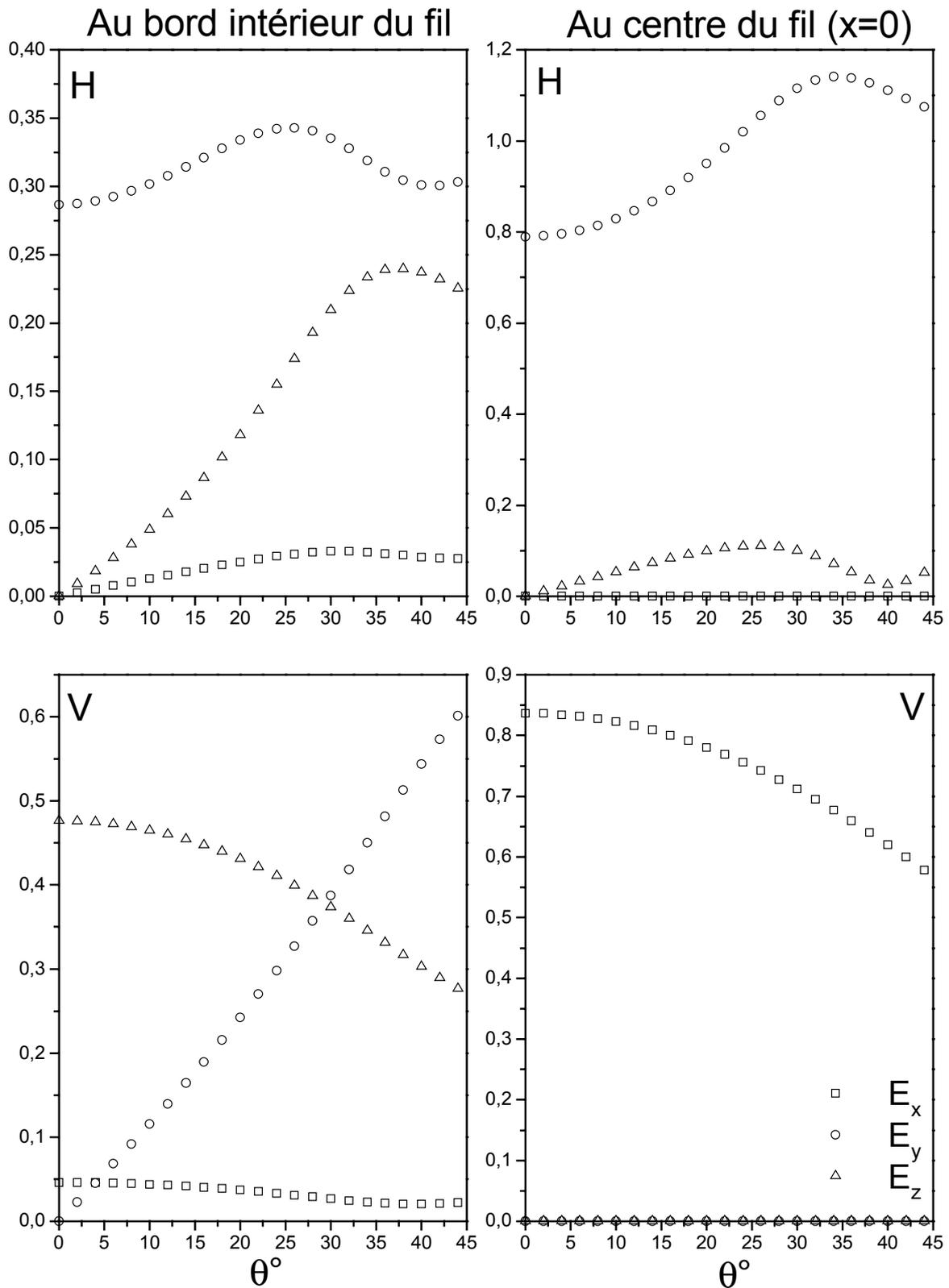
**Figure 3.8** Variations de l'amplitude des composantes du champ local en fonction de l'angle d'incidence. L'amplitude est mesurée au bord intérieur du fil (figures de gauche) et au centre du fil (droite). Les points nuls correspondent aux composantes impaires. Le calcul a supposé exactement les mêmes paramètres que ceux de la Figure 3.8.
