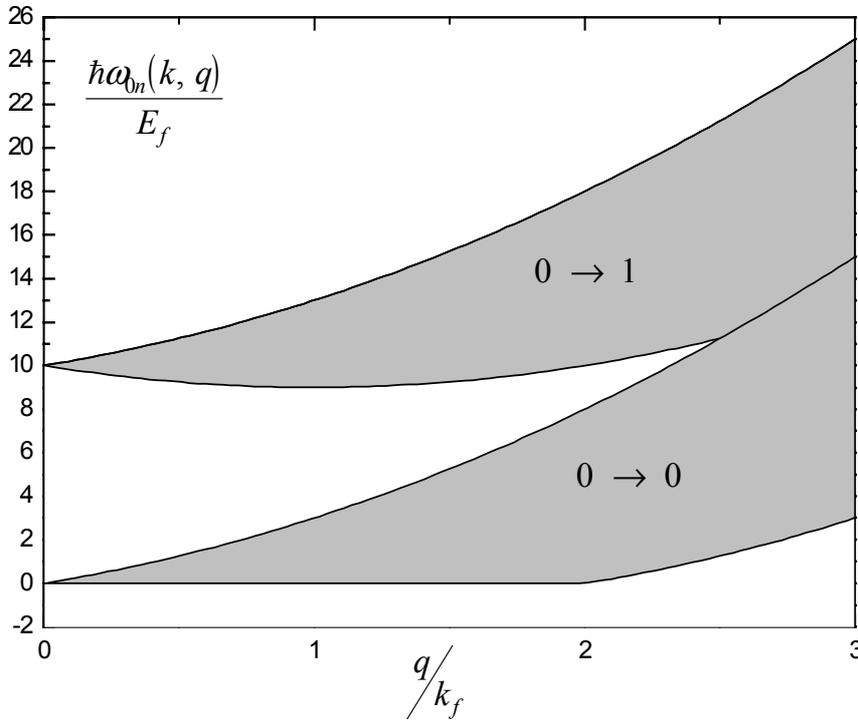
**Figure 2.3** Spectre des excitations à une particule d'un gaz d'électrons bi-dimensionnel n'ayant qu'une seule sous-bande occupée. (0-0) est la région des SPE intra-bande, (0-1) correspond aux excitations de 0 vers 1
