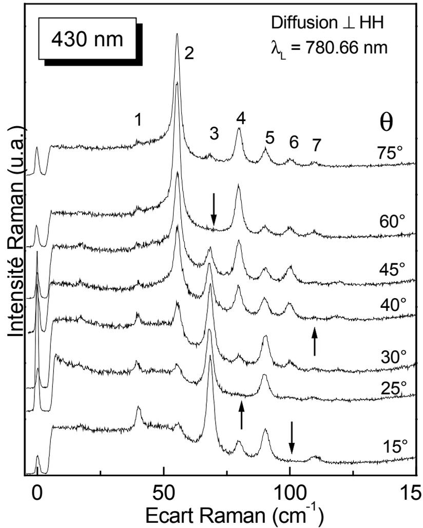
**Figure 4.23** Spectres obtenus sur le fil de 430 nm de large en diffusion perpendiculaire et polarisations parallèles pour différents angles d'incidence par rapport à la normale de l'échantillon..
