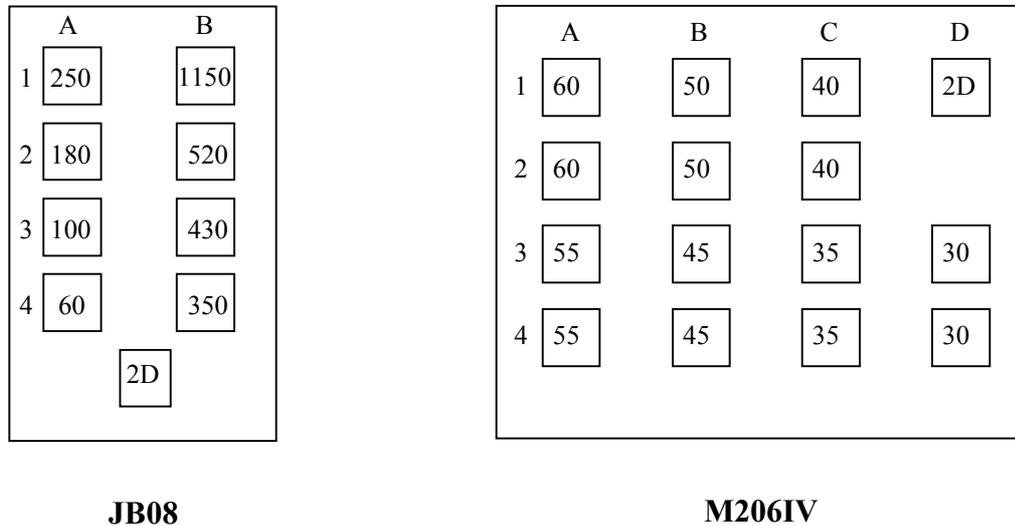
**Figure 4.4** Disposition des réseaux de fils quantiques sur chacun des échantillons. Pour le JB08, les nombres indiquent la largeur des fils en nanomètre mesurée au MEB après désoxydation partielle des réseaux. Pour le M206IV, les nombres sont ceux des largeurs nominales des fils (largeur codée corrigée de l'épaisseur d'oxyde)
