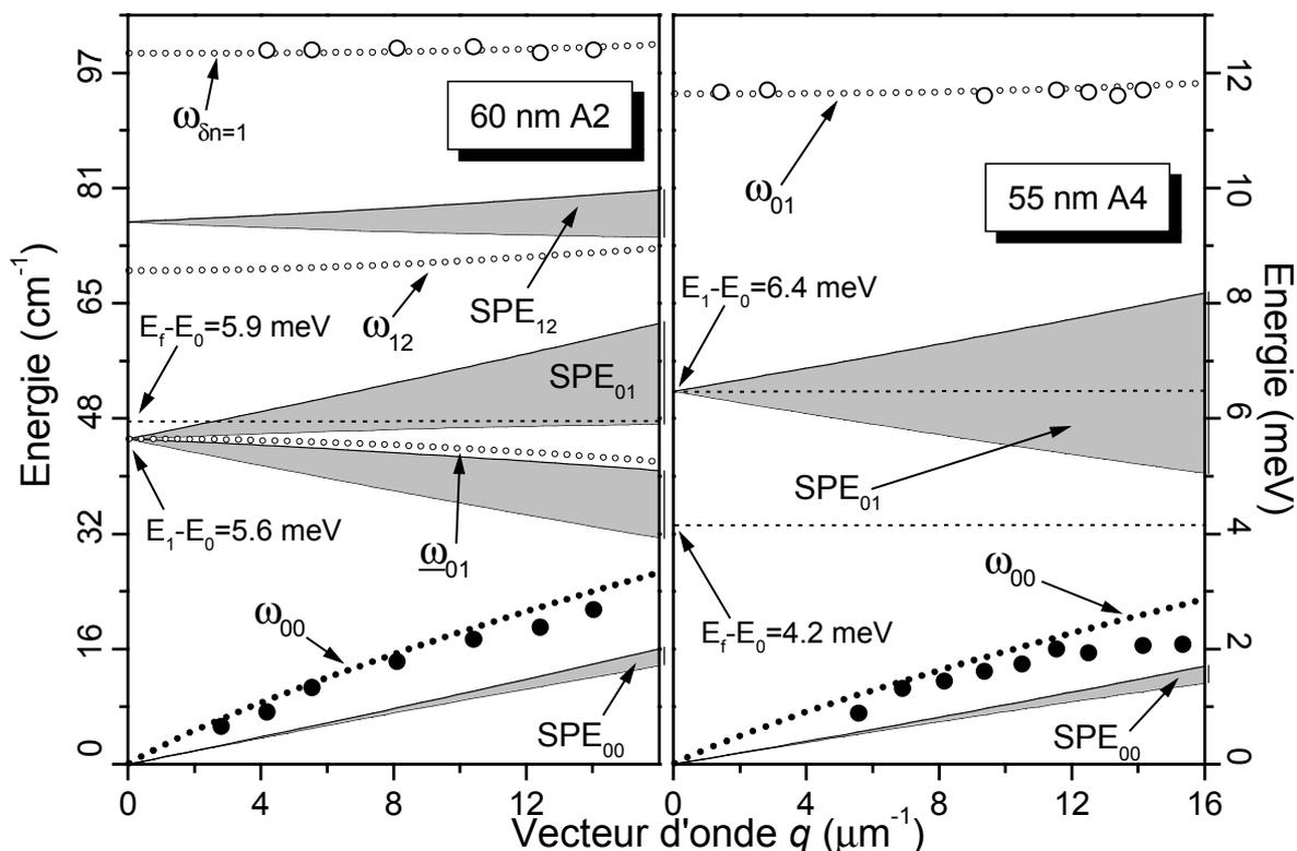
**Figure 4.28** Ajustement avec le modèle RPA des dispersions du plasmon intra-bande et du plasmon antisymétrique pour les fils de 60 nm ( $2a=55$  nm,  $n_{2D}=1.45$ , 2 sous-bandes occupées) et 55 nm. ( $2a=51$  nm,  $n_{2D}=1.07$ , 1 sous-bande occupée).
