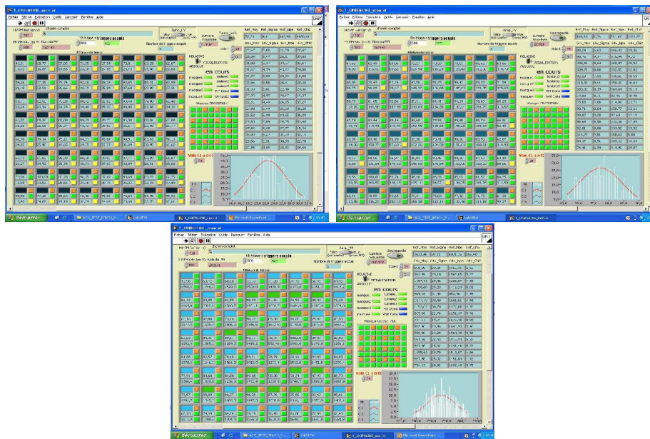
FIG. 4.31 – Capture d'écran de l'interface utilisateur obtenue à l'issue de la cartographie du photomultiplicateur. Sur la gauche est représenté un tableau 8 \times 8 dans lequel sont reportées les valeurs, soit relatives soit absolue, de la réponse des 64 voies du photomultiplicateur ainsi que le nombre de photoélectrons. On est également capable d'ajuster ces distributions avec la figure en bas à droite.
