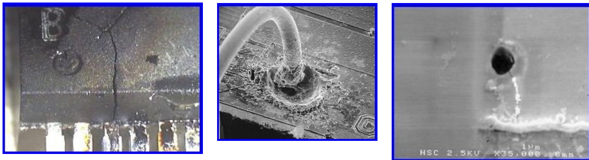
Destruction du boîtier
