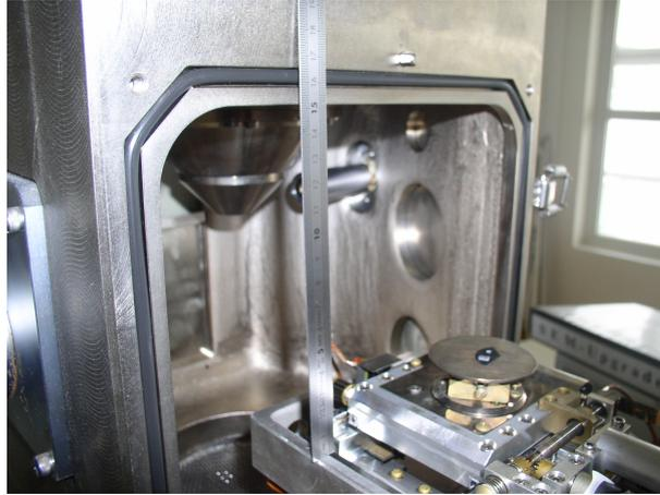
FIG. 1.5 – Enceinte restreinte d'un MEB d'un volume d'environ  $20 \text{ cm}^3$ .
