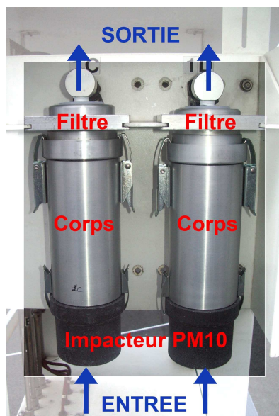
Figure 10 : Photo du Partisol 2300 et des cartouches de prélèvement
