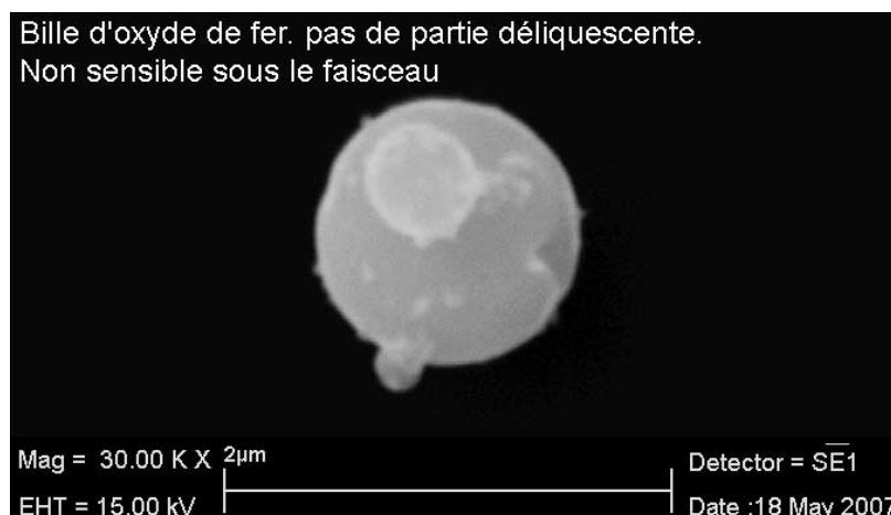
Figure 94 : Image en électrons secondaires d'une bille d'oxyde de fer rencontrée dans les particules « continentales métalliques »
