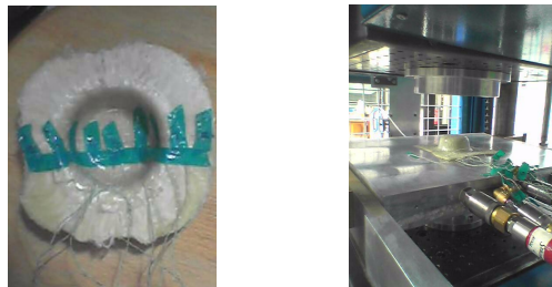
FIG. 3.13: Disposition des thermocouples sur le flan étudié.
