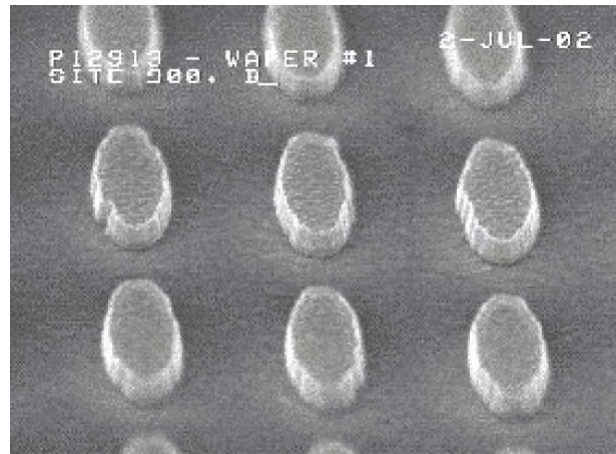
Figure 1.15 : Réseau de jonctions tunnels magnétiques de type Savtchenko. D'après [Durlam 2005].
