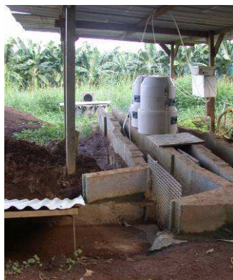
Figure 2-8 Dispositif de suivi hydrologique sur la parcelle Espérance Haut (d'après Cattan et al. (2006)) – en photo : le dispositif de mesure de débit et le canal collecteur.
