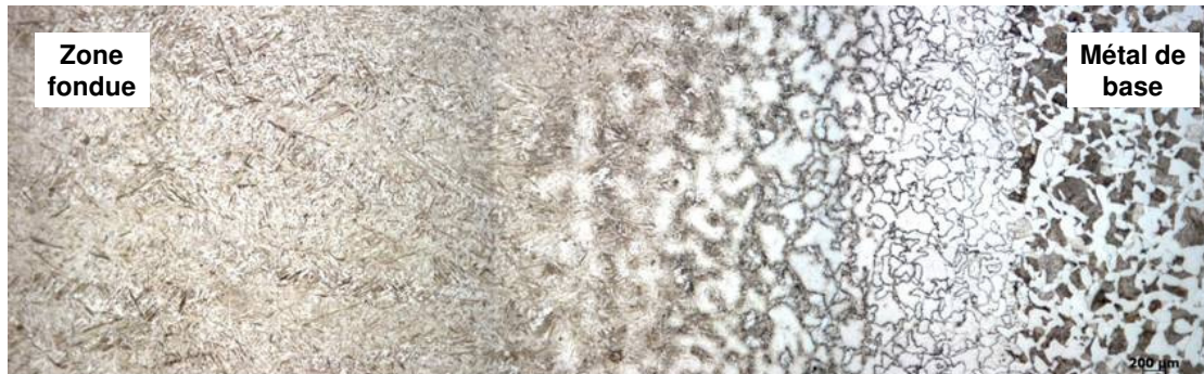
Figure IV-4 Vue transversale de la soudure laser après attaque Nital
