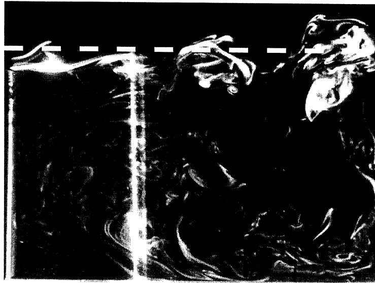
FIG. 4.21 – ( - - ) ligne traversant la couche cisailée le long de laquelle est effectuée l'autocorrélation. Exemple pour L/H=1,5 .
