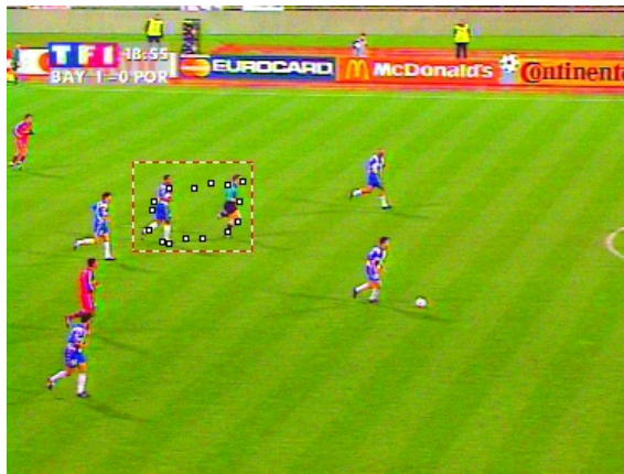
FIG. 7.6 – Répartition précise des points du snake avant l'exécution de la procédure de scission.
