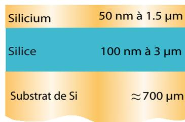
**Fig. 3.1** – Représentation schématique des différentes couches d'un substrat SOI.
