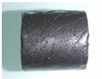
Cylindre 25x50mm de ZnCl_2 avec 15% m de Timrex SFG75
