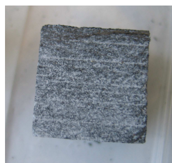
Echantillon (50x50x50mm) de KNO_3/NaNO_3 avec 10% m de GNE
