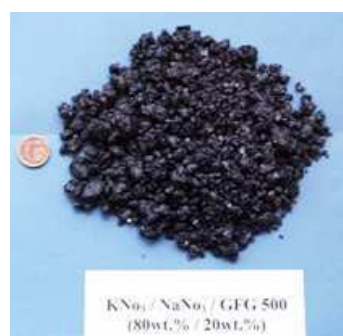
Granulats de KNO_3/NaNO_3 avec 20% m de GNE broyé à 500 \mu m (SGL)
