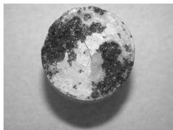
Matrice de GNE infiltré avec du KNO_3/NaNO_3 (PROMES)
