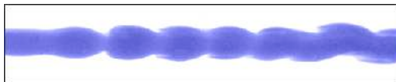
FIG. 6.2 – Photo de motifs de champignons, \tilde{R}_I=0.35 ; Re=20 ; M=25 . La hauteur de l'image est le diamètre du tube (2cm). L'injection est à la gauche de l'image.
