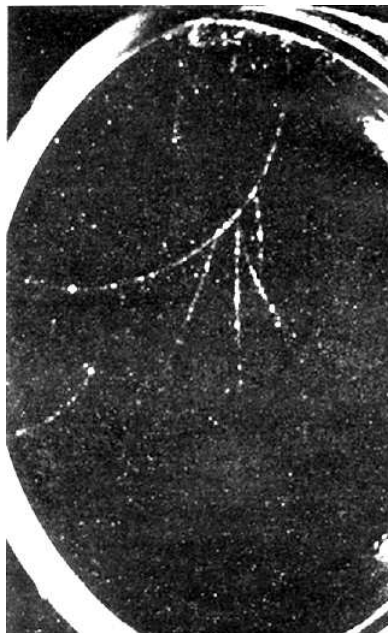
FIG. 2.2: Mise en évidence de la création de paires par Blackett & Occhialini [1933]. Sur cette photo on peut distinguer trois trajectoires suivies par des électrons et trois trajectoires suivies par des positrons. On peut voir un point d'origine commun à partir duquel les trajectoires de deux positrons divergent de celles de deux électrons.
