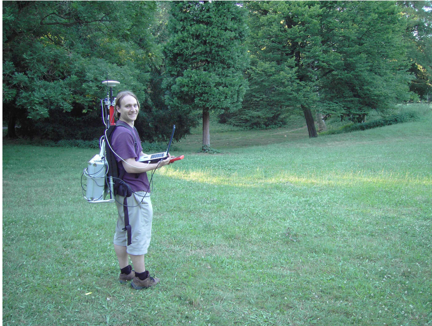
Abbildung 6.11: Beobachter beim Vermessen der Topographie mithilfe des ERS
