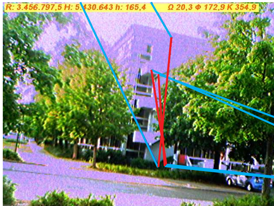
Abbildung 6.9: Abweichungen einer skizzierten Gerade bei größeren Störungen von IMU und GPS
