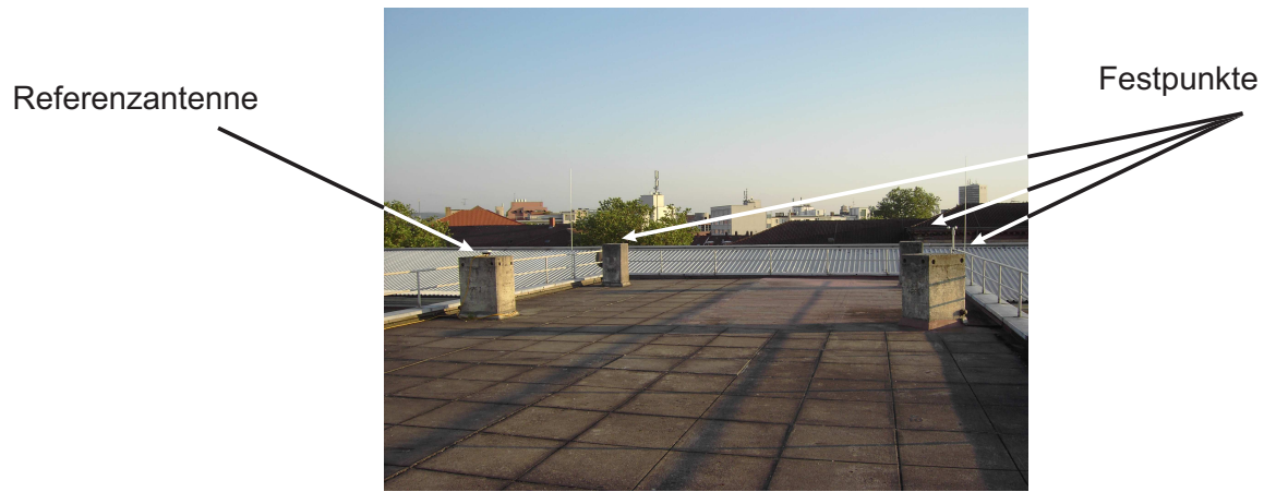
Abbildung 4.13: Passpunktfeld mit bekannten Koordinaten im GK-System
