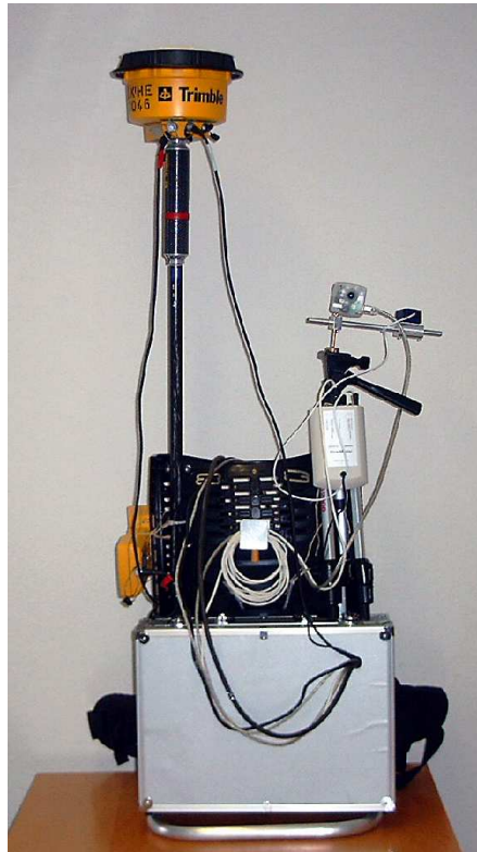
Abbildung 4.1: Rückansicht des ER-Systems; der Kraxe mit den Komponenten zur Visualisierung, Orientierungs- und Positionstracking, Stromversorgung und Systemsteuerung
