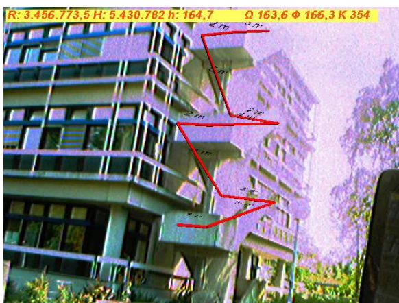
Abbildung 6.20: Verfeinerung der dreidimensionalen Skizze zur Beschreibung eines Weges auf einer Treppe: Ein weiteres Polygon verfeinert die beobachtete Linie weiter
