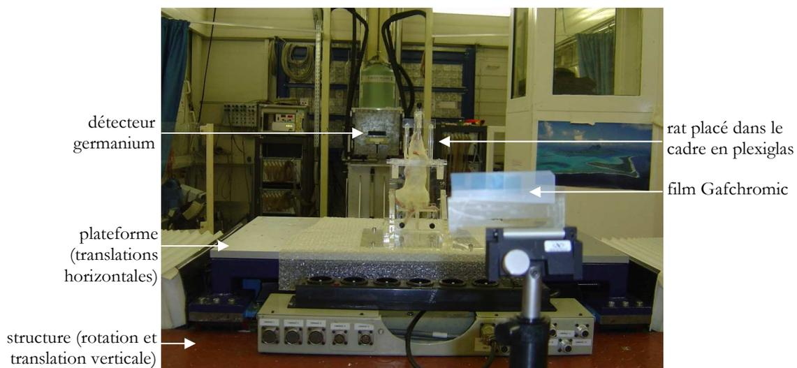
**Figure III-15** : Dispositif d'irradiation SSR : le rat est placé dans le cadre stéréotaxique en plexiglas, fixé sur la plateforme. La tumeur est positionnée sur l'axe de rotation de la structure pour une irradiation en mode tomographie. Le film Gafchromic est placé en amont du rat afin de vérifier la contiguïté des coupes d'irradiation. Le détecteur germanium permet une mesure de la dose.
