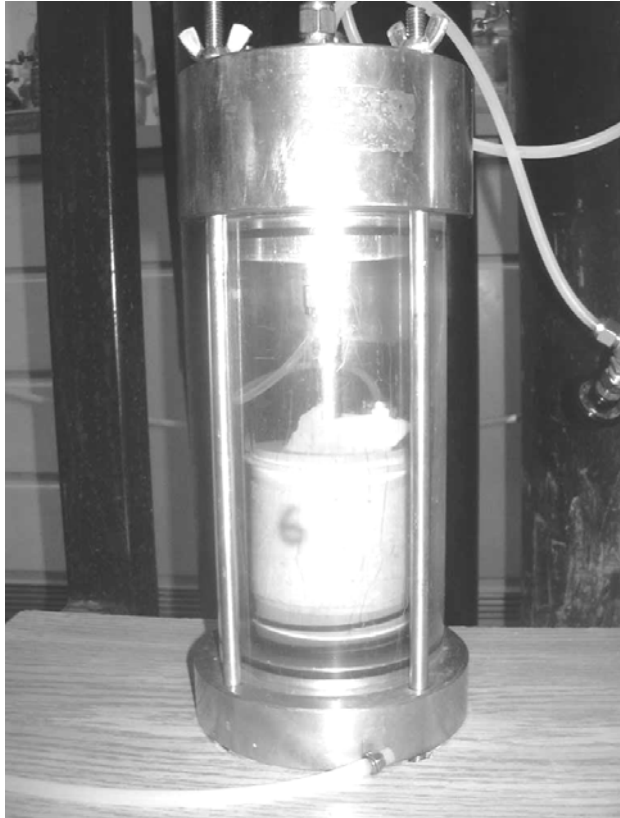
Figure II. 6 : Photographie d'une cellule Bernaix.
