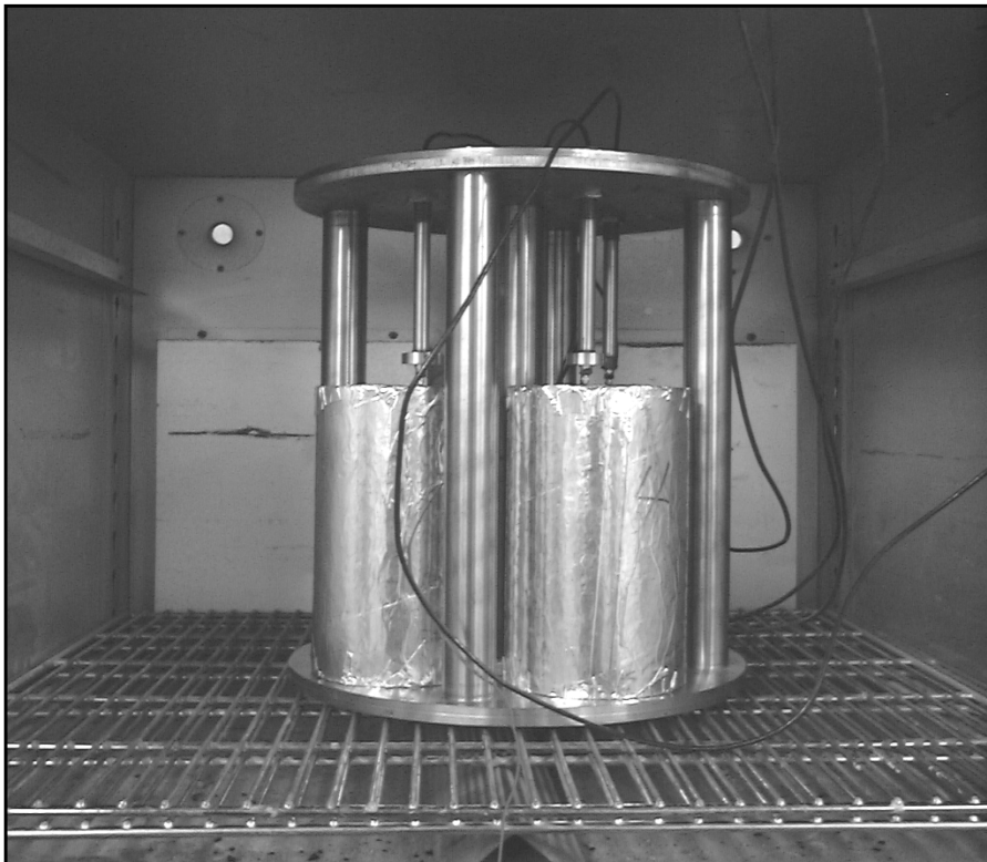
Figure II. 2: Dispositif de mesure du coefficient de dilatation thermique dans l'enceinte thermorégulée.
