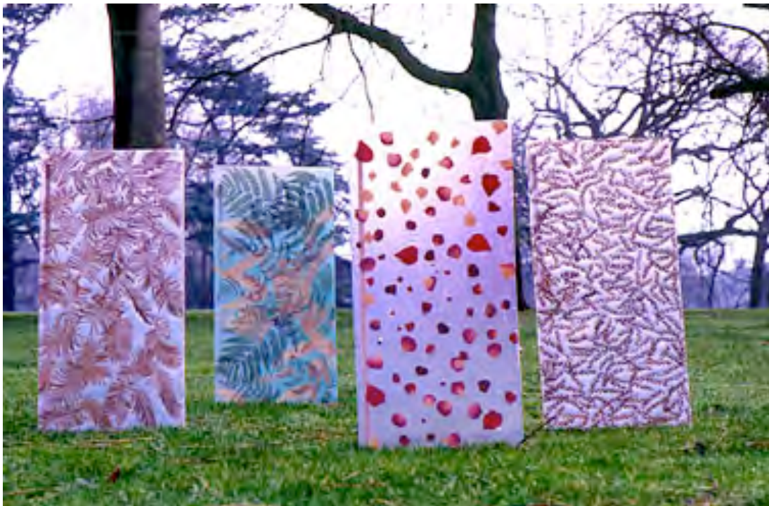
Prototypes d'inclusions végétales dans des panneaux composites (document Jean de Giacinto)
