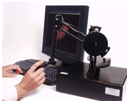
FIG. 3.17 – Interface haptique PHANToM 1.5/6DOF de SensAble Technologies.
