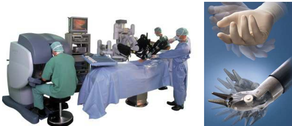
FIG. 2.13 – Système maître-esclave DaVinci de la société Intuitive Surgical à gauche et organe terminal EndoWrist à droite.
