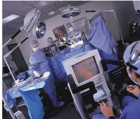
FIG. 2.12 – Système maître-esclave Zeus de Computer Motion
