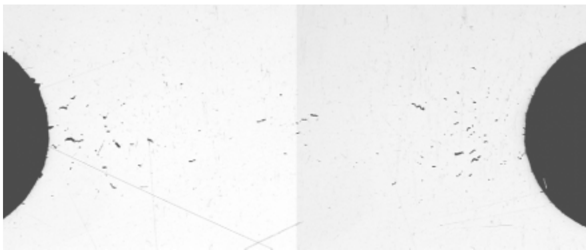
Figure 210 : Coupe longitudinale d'une éprouvette FLE 1-6 en acier 316L(N) à l'état hypere trempé testée en fluage à 600^{\circ}\text{C} sous 320 \text{ MPa} , interrompu après 3094 heures, diamètre minimal après déformation: 5.65 \text{ mm}
