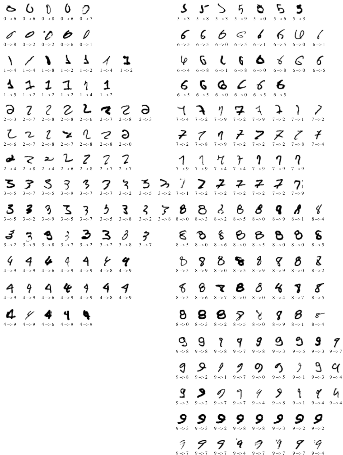
Fig. 3.20. Images mal reconnues et confusions réalisées sur la base de test de MNIST
