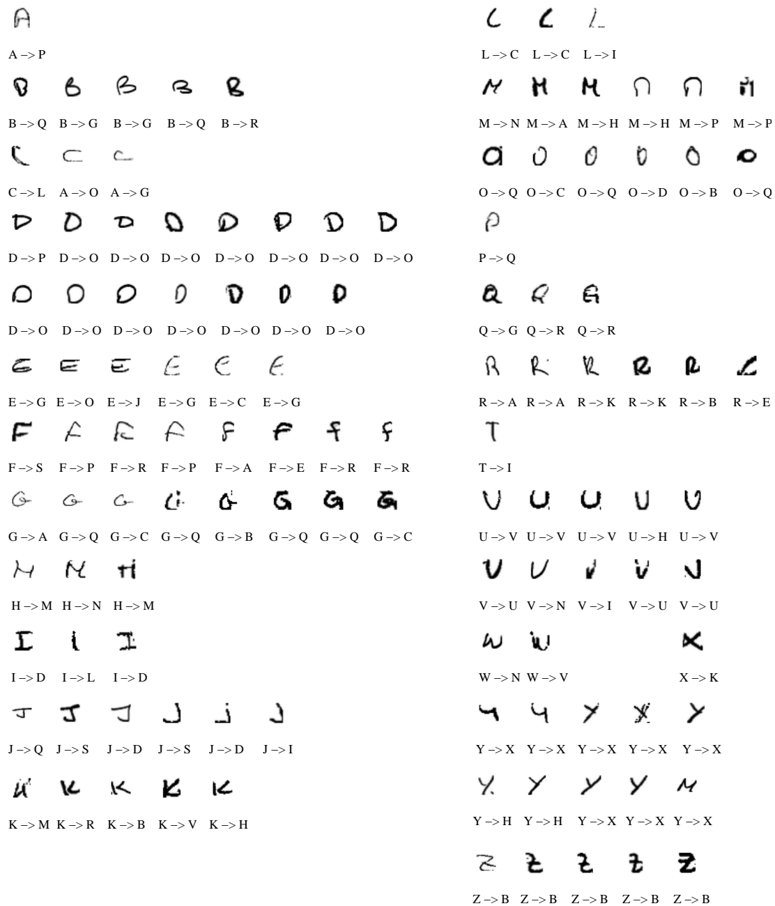
Fig. 3.24. Images mal reconnues et confusions réalisées sur la base ENST-FAX-CHAR
