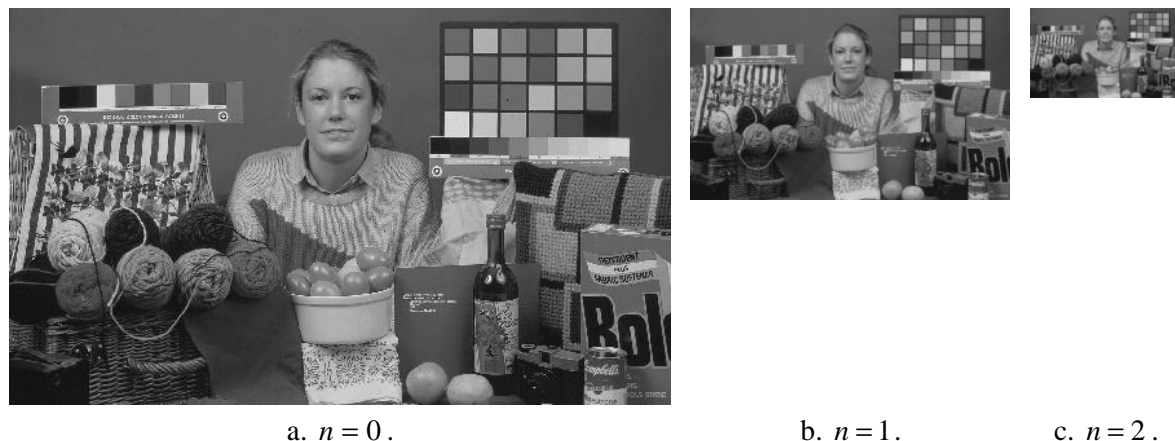
Figure 2.6. Pyramide gaussienne à trois niveaux de résolution pour une image de la séquence MIT.
