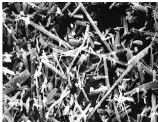
FIG. II.9 – Structure aciculaires de la wollastonite
