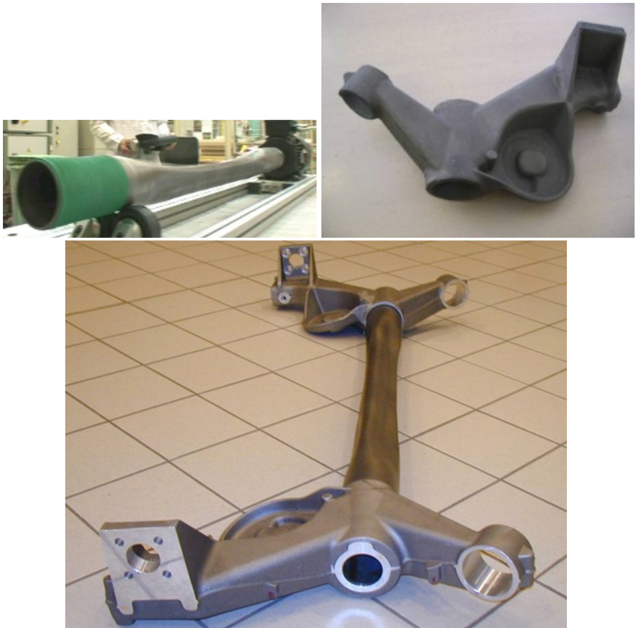
FIG.B - Train arrière de voiture assemblée par collage structural
