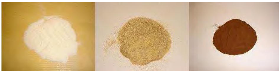
Figure III-14 : Poudres de cellulose microcristalline, de xylane de hêtre et de lignine alcali (de gauche à droite)
