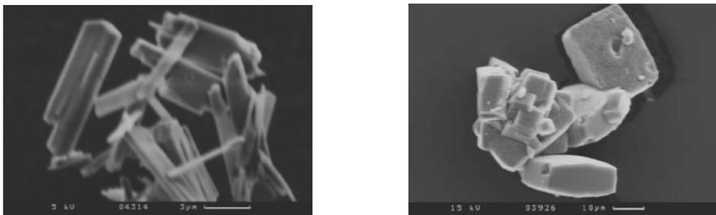
Figure 11: Photographie de MOR brute de synthèse obtenue par microscopie électronique à balayage
