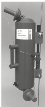
Une bouteille **Niskin** (ancienne appellation : « bouteille Nasen ») se présente sous la forme d'un tube cylindrique, fixé le long d'un câble et ouvert à ses deux extrémités dans un premier temps, pour laisser passer l'eau lors de la descente dans la colonne d'eau.
