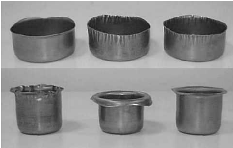
FIG. 6.3 – Photos de godets emboutis après la première étape (partie haute) et la deuxième étape (partie basse).
