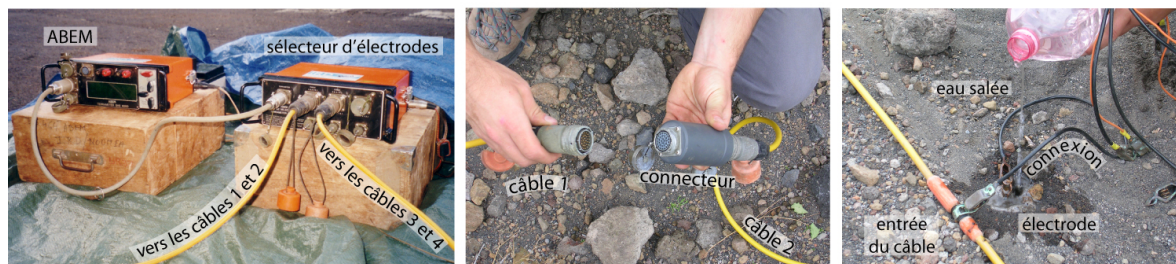
Figure III-27 : Configuration de terrain et matériel utilisés en tomographie de résistivité électrique. Représentation schématique du dispositif ; nous avons utilisé un écartement de 10 m entre les 64 électrodes connectées aux câbles et un protocole Wenner- \alpha (Photos : 1 - S. Barde Cabusson ; 2 et 3 - N. Carzaniga).
