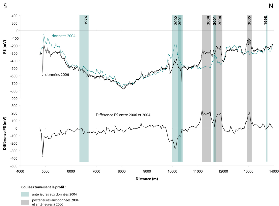
Figure III-33 : Section du profil PS de la RN2 où des données PS avaient déjà été acquises en 2004 (Levieux, 2004) et entre 1990 et 1997 (Boubekraoui and Aubert, 1999). Le graphique inférieur représente la différence entre les données de 2004 et celles de 2006.
