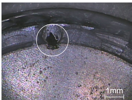
Figure 4-12 : Claquage d'un composant Tha (x40 et x200).
