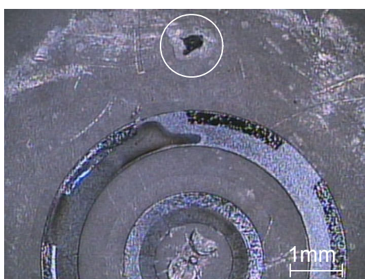
Figure 4-13 : Claquage du composant Thc3 (x40 et x200).
