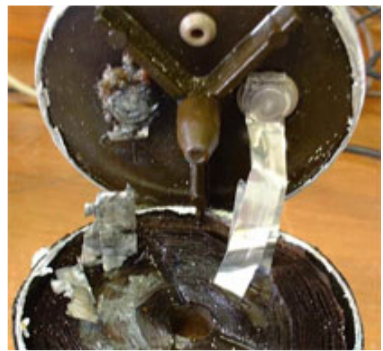
Figure 2-20 : Corrosion de l'anode d'un composant A.
