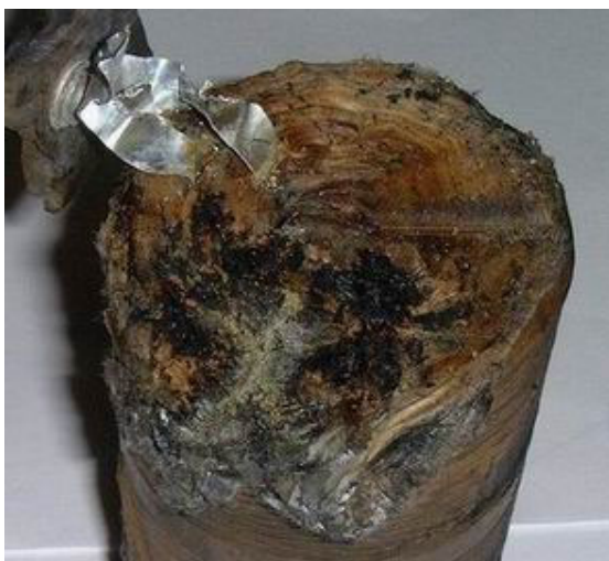
Figure 2-19 : Composant B après explosion.
