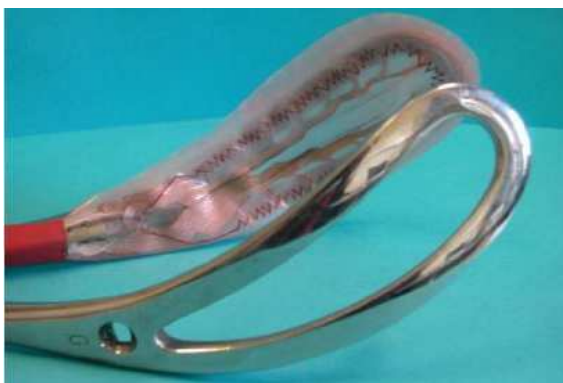
(a) Forceps instrumentés avec des capteurs de pression d'interface
