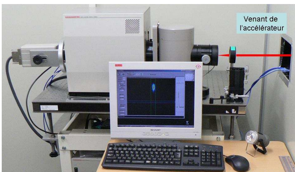
Figure VI-18- La camera à balayage de fentes.
