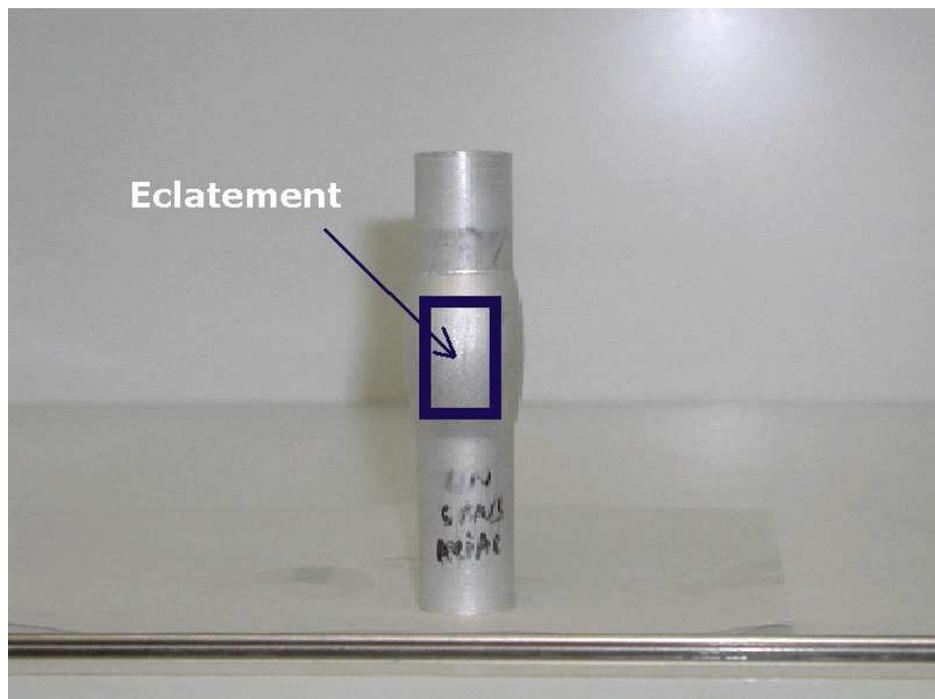
FIG. 5-4: Pour une pression de 6.3 MPa, on observe l'apparition du zone d'éclatement du tube au centre de la zone en expansion.
