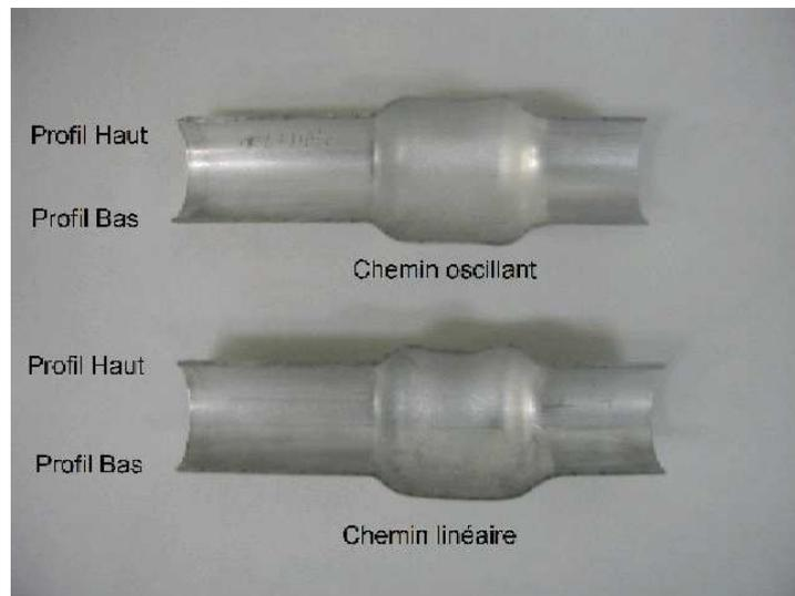
FIG. 5-18: Comparaison entre les profils pour le procédé linéaire et le procédé oscillant.
