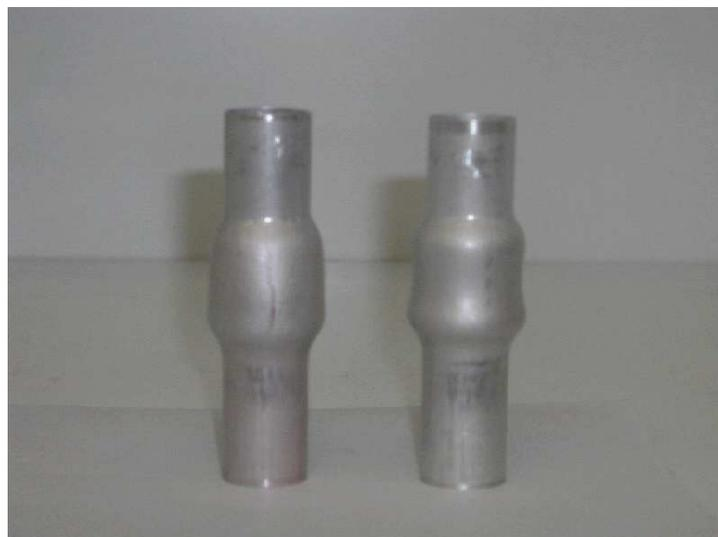
FIG. 5-9: Apparition de rupture sur le tube lors du procédé de hammering (gauche). Apparition de flambage lors d'un procédé linéaire (droite)
