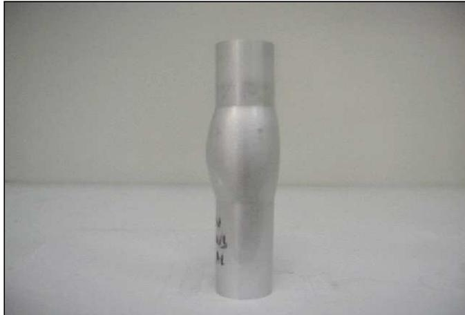
FIG. 5-5: On constate que la déformation du tube n'est pas axisymétrique.
