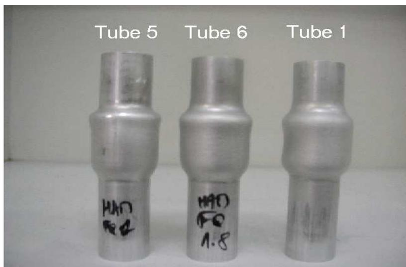
FIG. 5-26: Comparaison de la géométrie obtenue pour des nombres de cycle valant 40 (Tube 5), 75 (Tube 6) et 105 (Tube 1).
