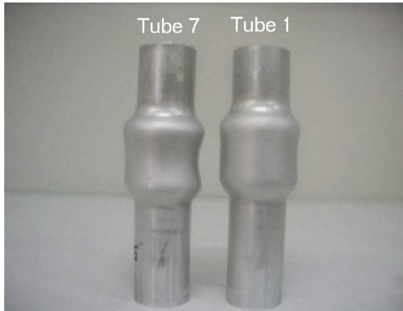
FIG. 5-30: Comparaison de la géométrie finale pour un procédé oscillant d'amplitude 0.5 MPa (Tube 7) et un procédé oscillant d'amplitude 1 MPa (Tube 1).
