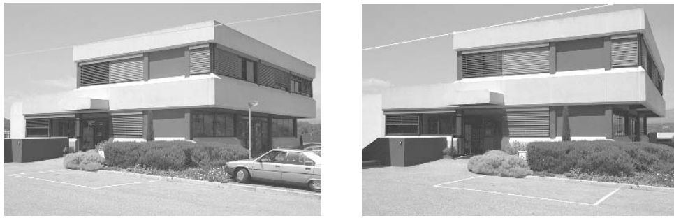
FIG. 5.22 – Le choix d'un deuxième point (contraint sur une droite épipolaire) détermine sans ambiguïté la position de ses correspondants dans toutes les autres images.
