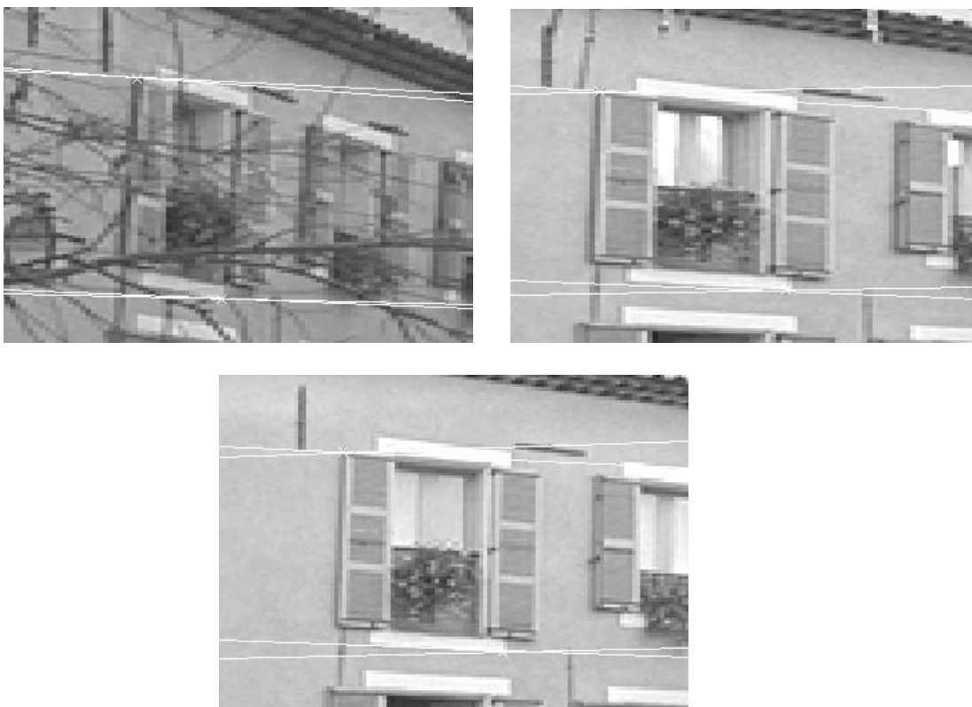
FIG. 3.26 – Détails de la géométrie épipolaire calculée sur la place des Arcades. Trois des huit images sont présentées. Elles appartiennent à trois blocs différents (deuxième, cinquième et septième images)
